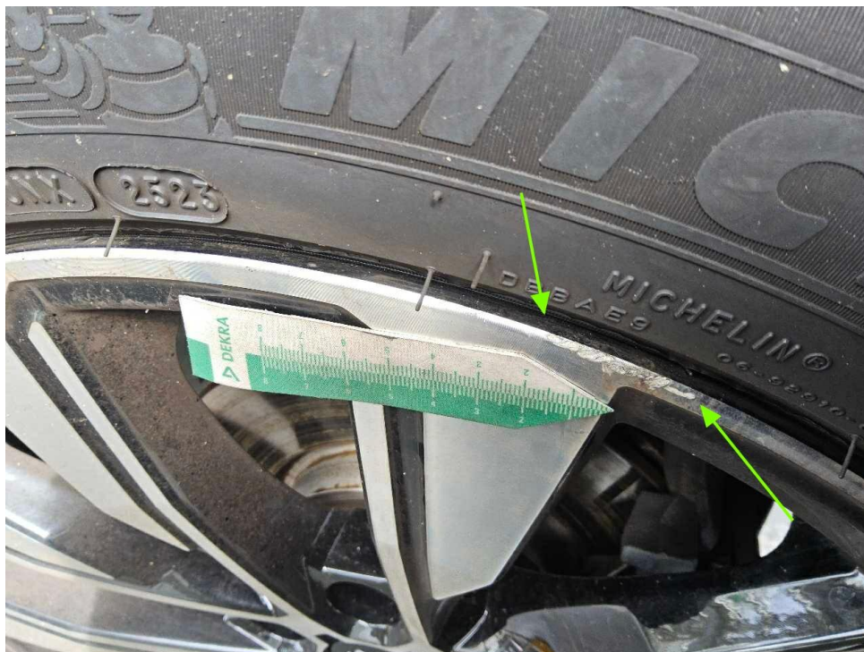
Bild 17 : Glanzgedrehte Felge vorne rechts, zerkratzt
