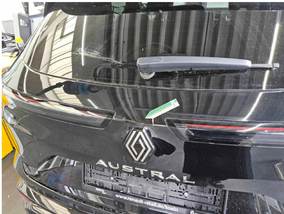
Bild 11 : Heckdeckel Lackierung, zerkratzt, lackieren
