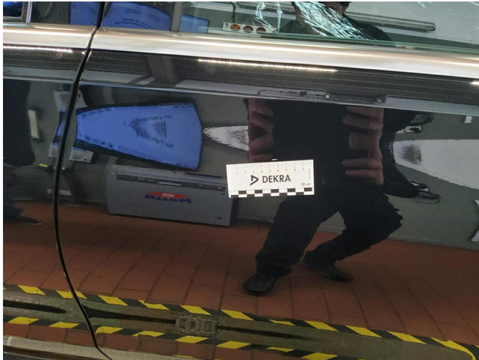
Bild 18 : Tür hinten links Lackierung, Steinschlag, lackieren mit Lackaufbau
