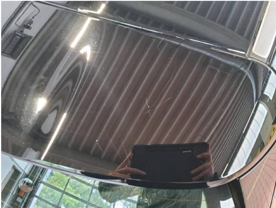
Bild 16 : Heckspoiler Lackierung, verschrammt, polieren
