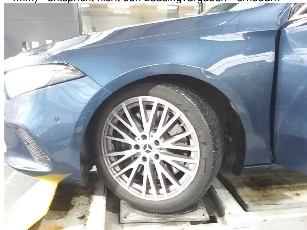
Beschädigung #4: Rad/Reifen: Reifen vorn (Winter, Profiltiefe <4mm) - entspricht nicht den Leasingvorgaben - erneuern
