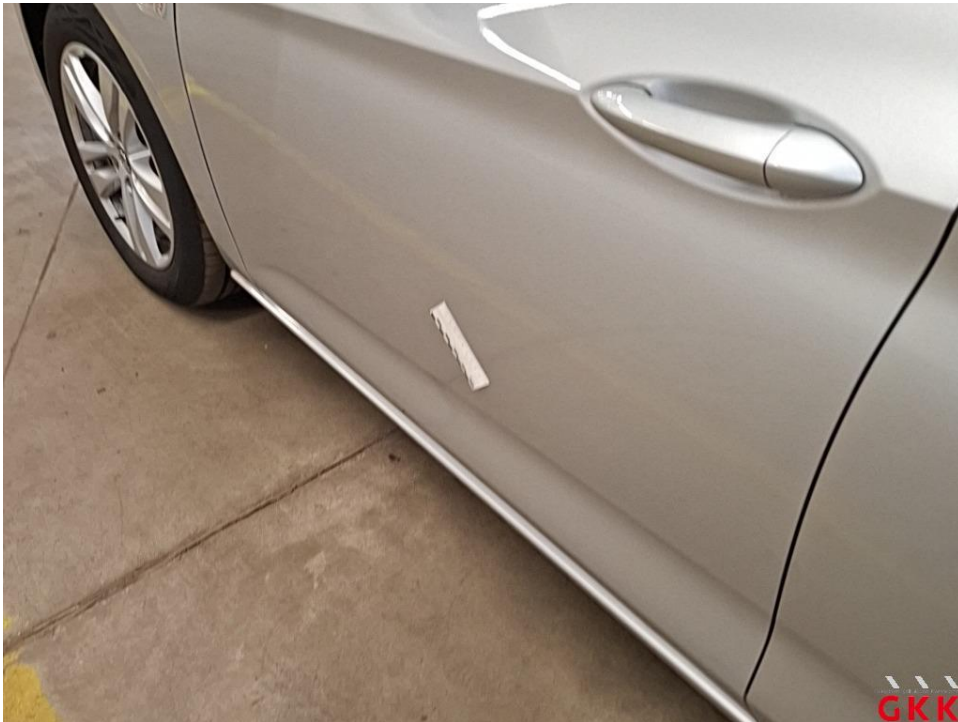
Bild 15 Tür vorne links, beschädigt, instand setzen - lackieren
