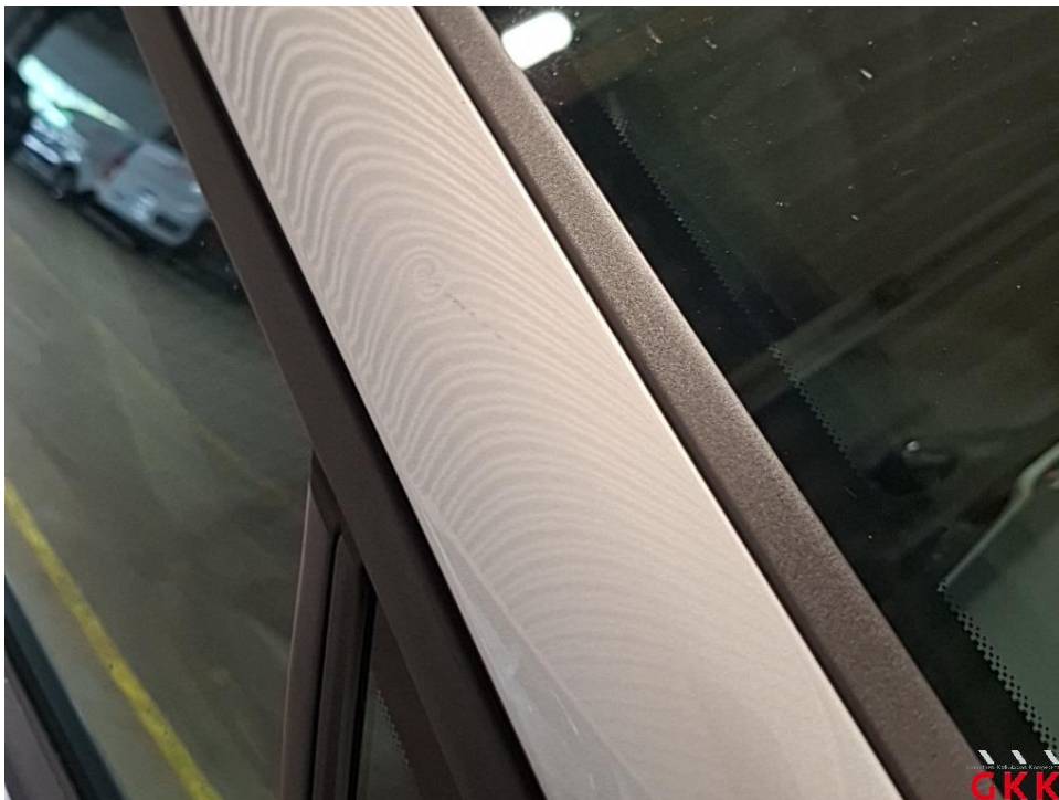
Bild 18 A- Säule rechts, beschädigt, Smartrepair
