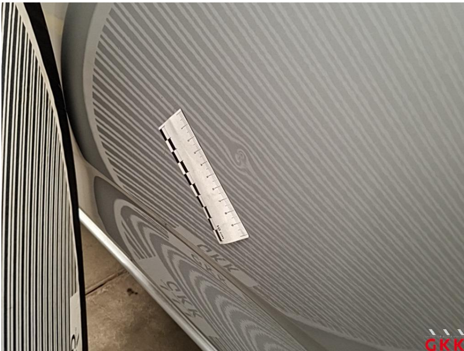
Bild 16 Tür vorne links, beschädigt, instand setzen - lackieren
