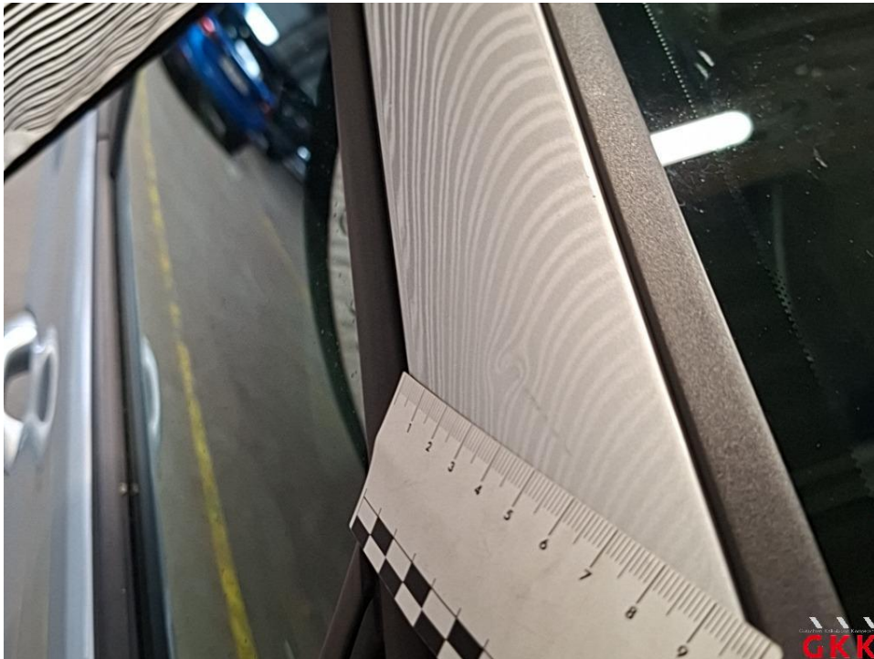
Bild 19 A- Säule rechts, beschädigt, Smartrepair
