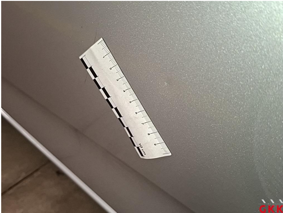
Bild 17 Tür vorne links, beschädigt, instand setzen - lackieren
