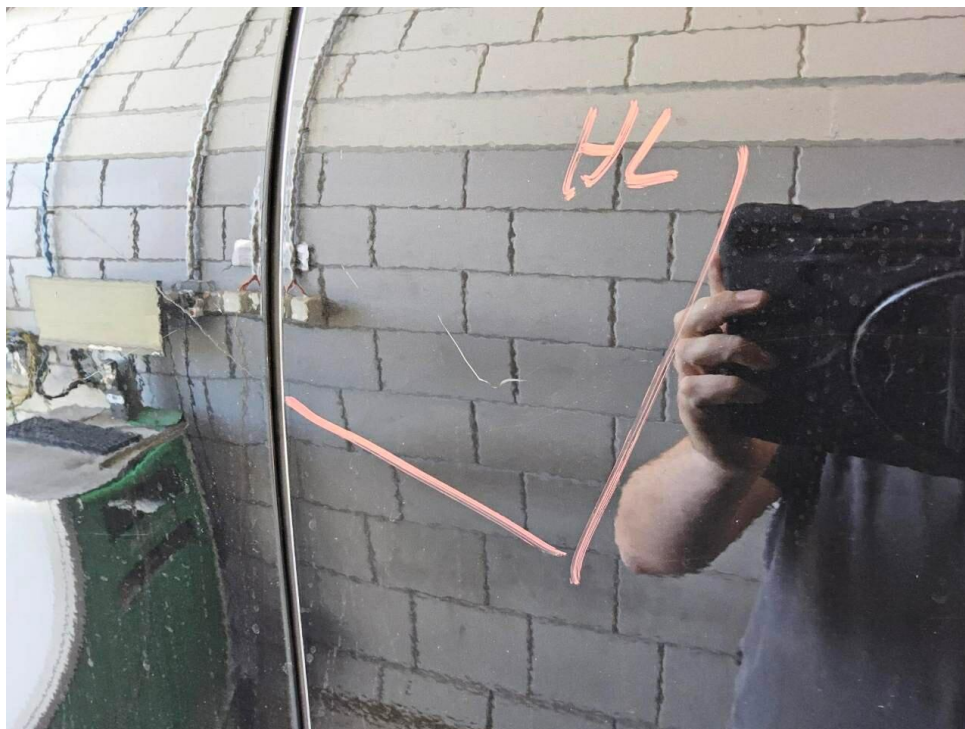
Bild 19 : Tür hinten links Lackierung, verschrammt, lackieren
