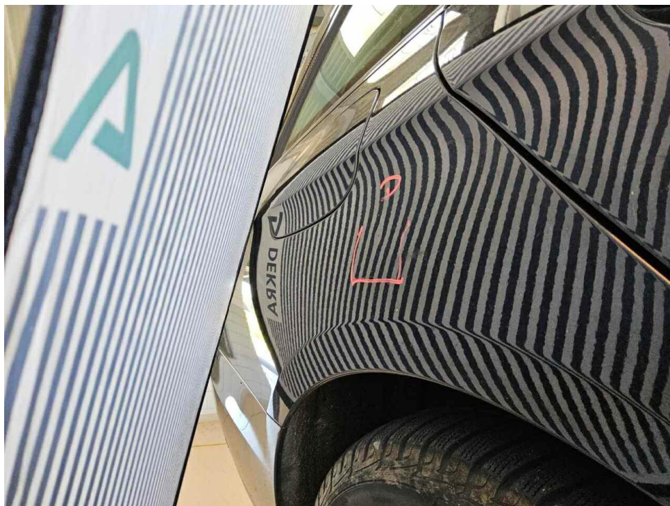
Bild 15 : Seitenteil hinten rechts, eingedellt, drücken
