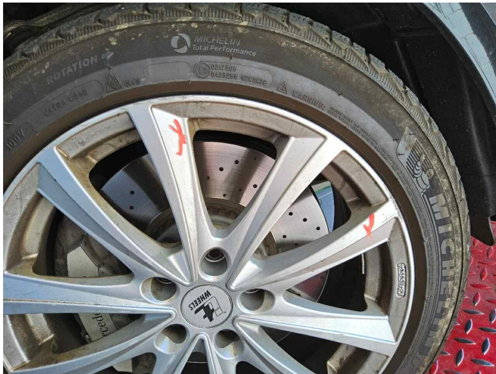
Bild 25 : Felge vorne links deformiert
