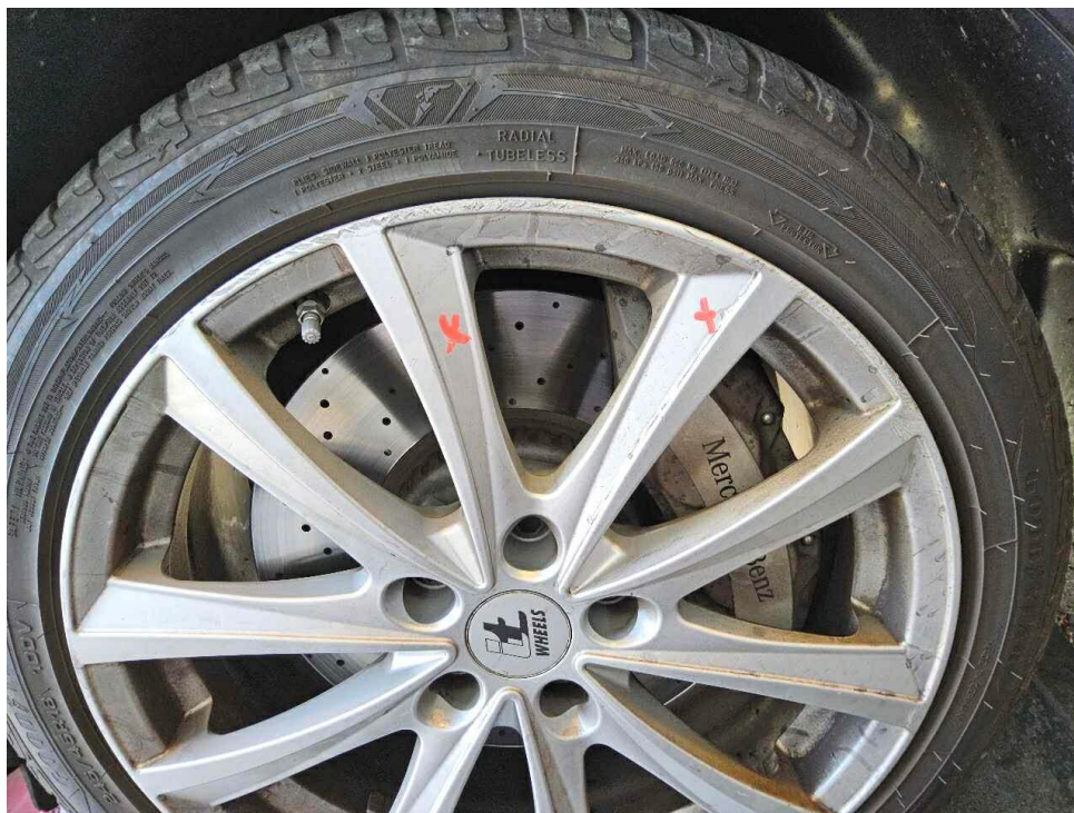
Bild 24 : Felge vorne rechts deformiert
