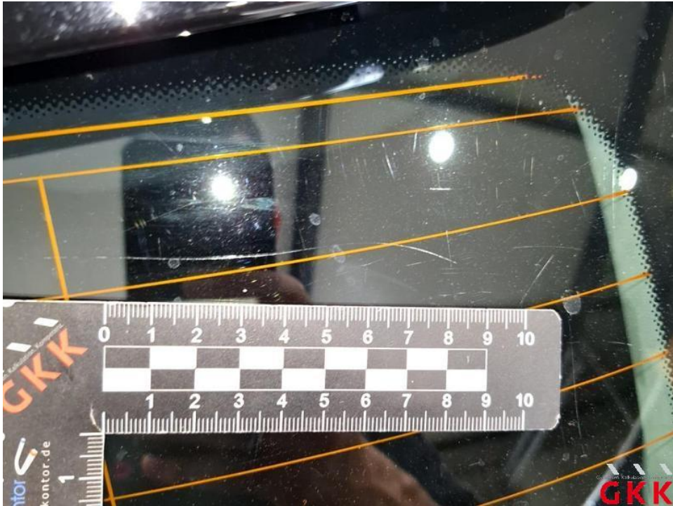
Bild 33. Heckscheibe, verkratzt, ersetzen
