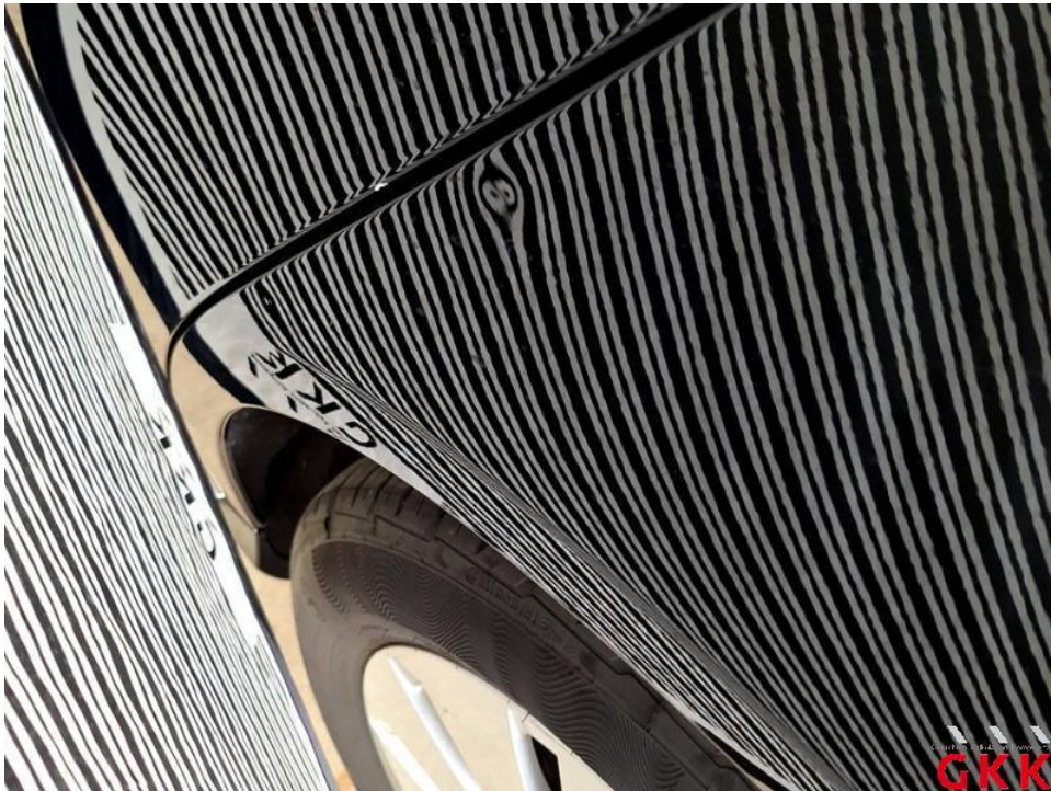
Bild 30. Seitenwand links, bis 3 Dellen / Bauteil, kalt drücken
