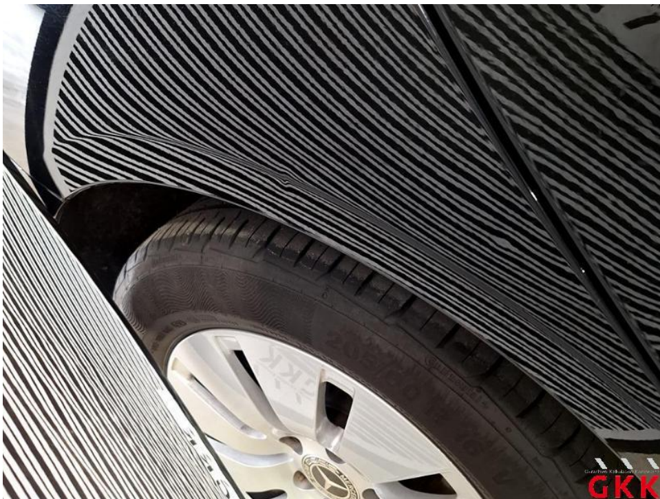
Bild 42. Seitenwand rechts, bis 3 Dellen / Bauteil, kalt drücken
