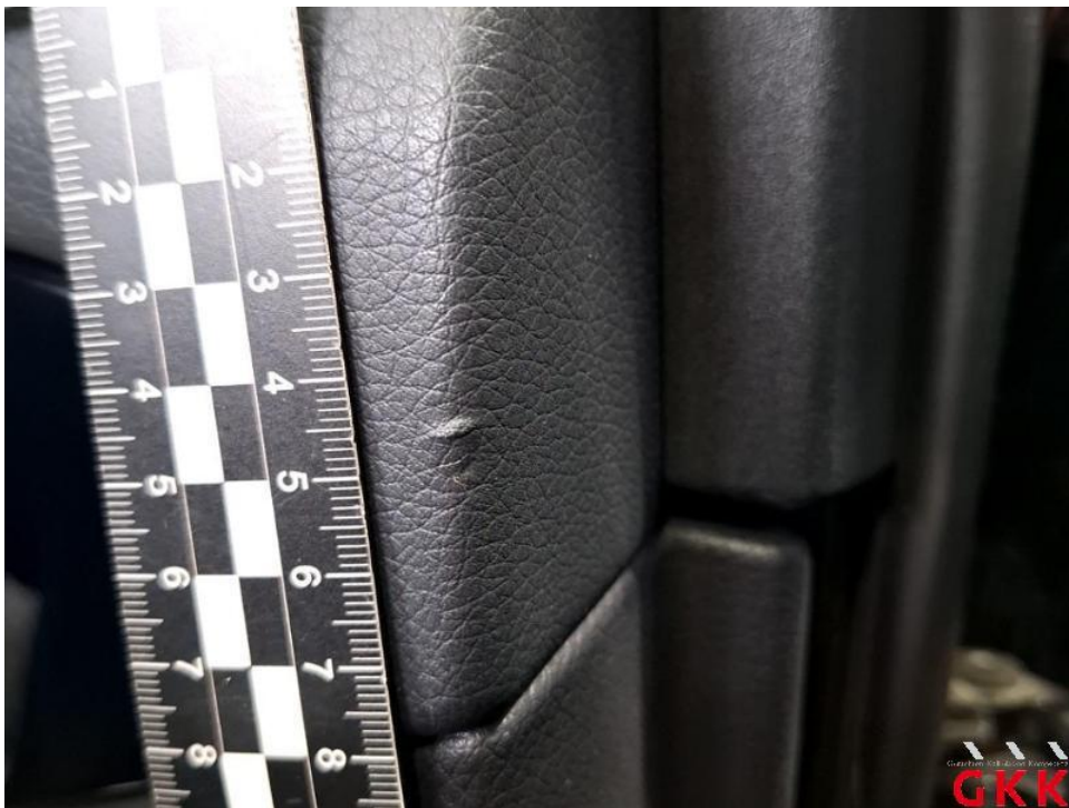
Bild 26. Tür hinten links, Innenverkleidung -Leder-, beschädigt, Smartrepair
