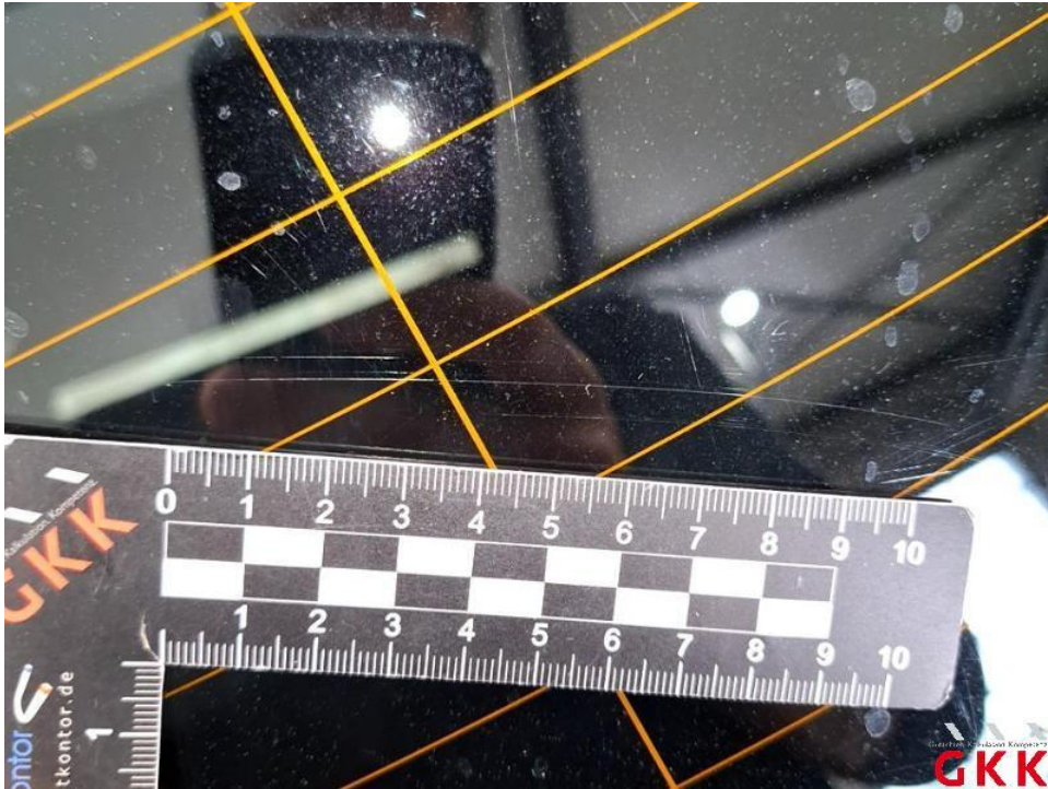
Bild 35. Heckscheibe, verkratzt, ersetzen
