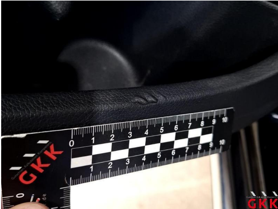
Bild 25. Tür hinten links, Innenverkleidung -Leder-, beschädigt, Smartrepair
