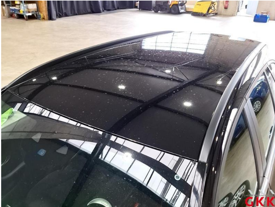
Bild 27. Dach, Steinschlag und Kratzer, auslegen, schleifen, polieren
