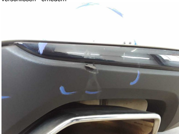
Beschädigung #7: Stossfänger hinten: Spoiler - verformt - erneuern
