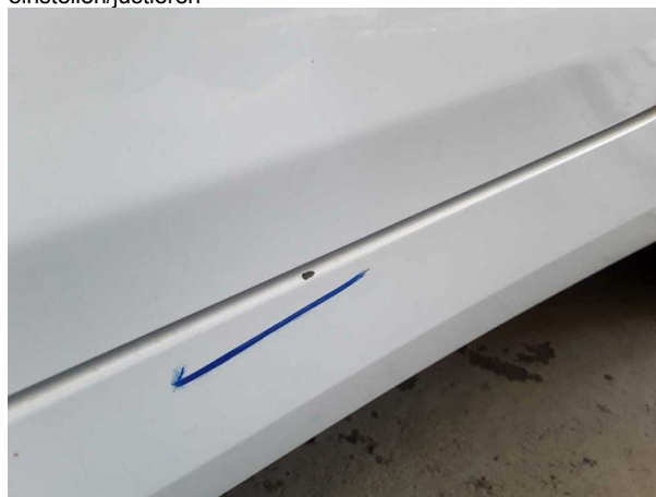
Beschädigung #4: Schweller links: Verkleidung - verkratzt / verschürft - Smart Repair
