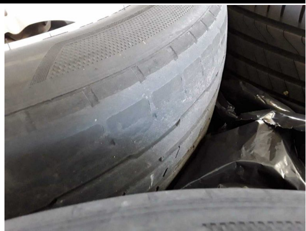
Damage #6: 2nd wheel set: 2 tyres (außen abgefahren) - Worn - Replace
