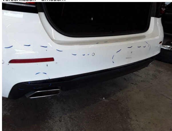
Beschädigung #7: Stossfänger hinten: Spoiler - verformt - erneuern
