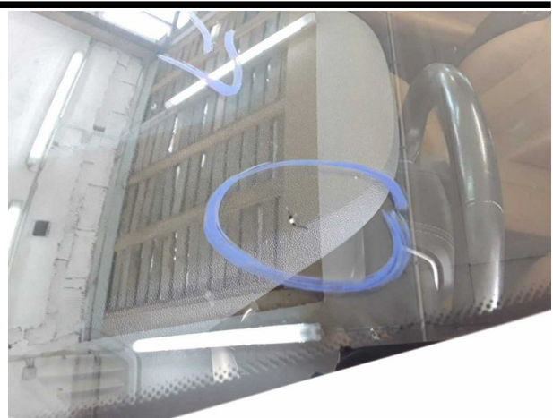
Beschädigung #10: Verglasung: Frontscheibe (Rissbildung) - Steinschlag - erneuern
