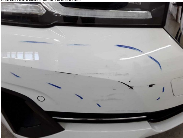
Beschädigung #9: Stossfänger vorn: Stossfänger mit Parktronic - verkratzt / verschürft - instandsetzen und lackieren
