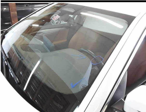
Beschädigung #10: Verglasung: Frontscheibe (Rissbildung) - Steinschlag - erneuern
