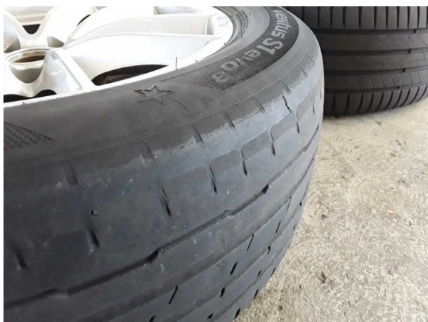
Beschädigung #3: Vermessung: Fahrwerk - Fehlstellung - einstellen/justieren
