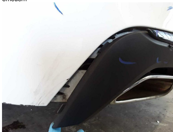
Beschädigung #7: Stossfänger hinten: Spoiler - verformt - erneuern
