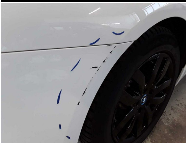
Beschädigung #12: Stossfänger hinten: Stossfänger mit Parktro... - verformt - erneuern
