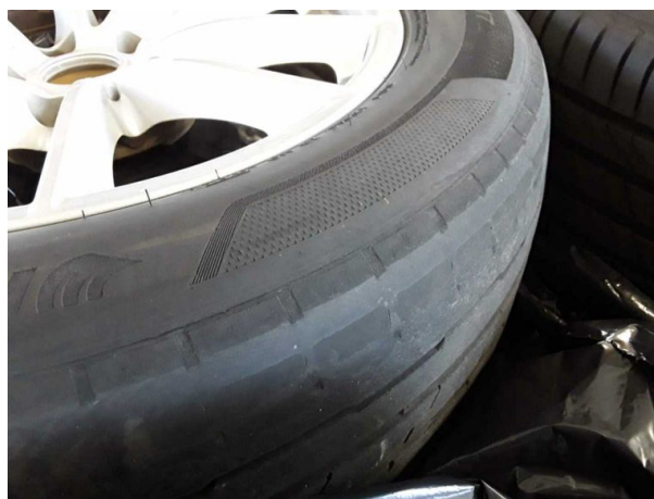
Beschädigung #3: Vermessung: Fahrwerk - Fehlstellung - einstellen/justieren
