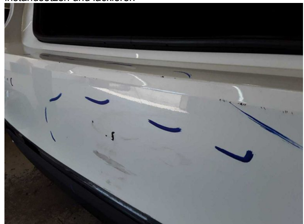
Beschädigung #12: Stossfänger hinten: Stossfänger mit Parktronic - verformt - erneuern
