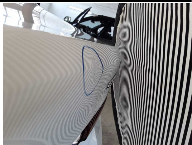
Beschädigung #8: Heckklappe/-tür: Heckklappe - Delle(n) - instandsetzen und lackieren
