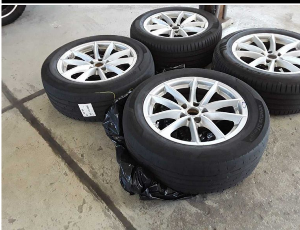
Damage #6: 2nd wheel set: 2 tyres (außen abgefahren) - Worn - Replace
