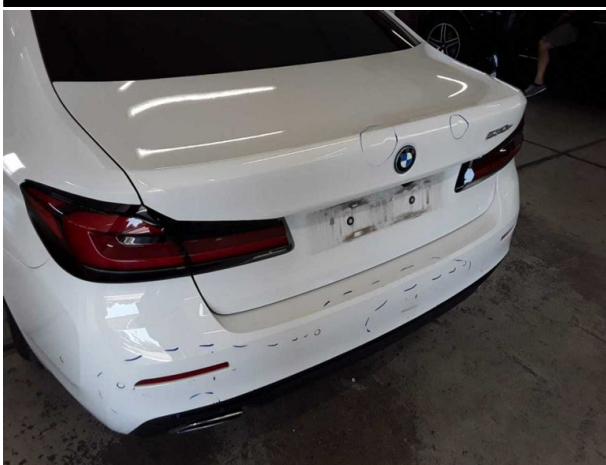
Beschädigung #8: Heckklappe/-tür: Heckklappe - Delle(n) - instandsetzen und lackieren
