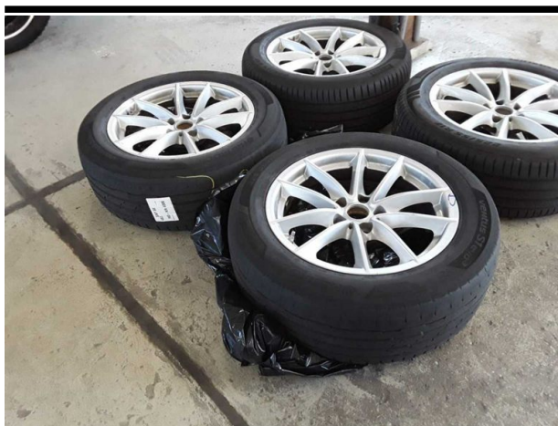
Beschädigung #6: 2.Radsatz: 2 Reifen (außen abgefahren) - verschlissen - erneuern
