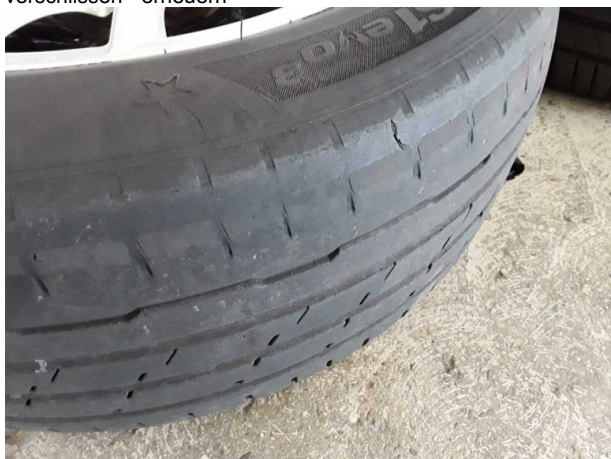
Beschädigung #6: 2.Radsatz: 2 Reifen (außen abgefahren) - verschlissen - erneuern
