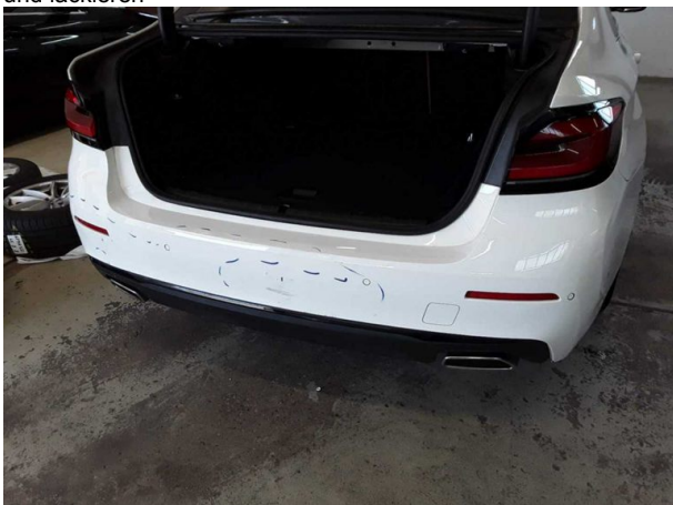
Beschädigung #12: Stossfänger hinten: Stossfänger mit Parktro... - verformt - erneuern
