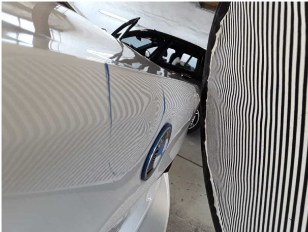
Beschädigung #8: Heckklappe/-tür: Heckklappe - Delle(n) - instandsetzen und lackieren
