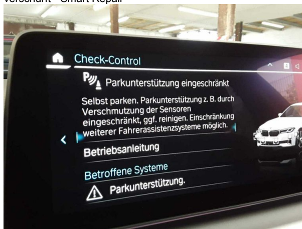
Beschädigung #5: elektronische Systeme: Einparkhilfe (Fehlermeldung) - Befund festlegen - Diagnose durchführen
