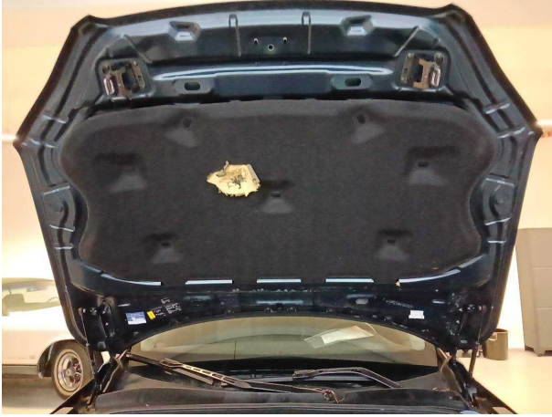
Beschädigung #1: Motorhaube: Dämmmatte - Marderschaden - erneuern
