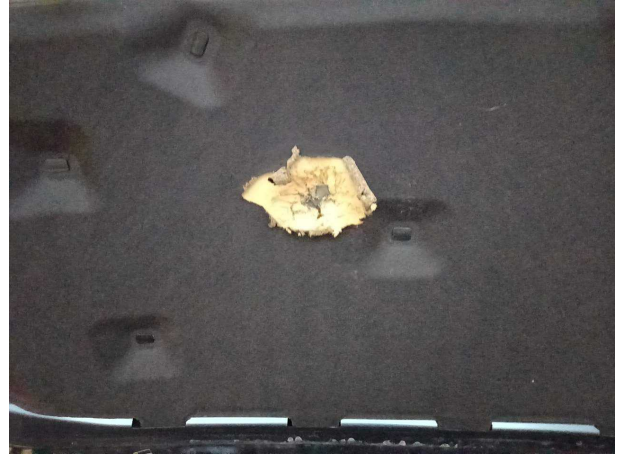
Beschädigung #1: Motorhaube: Dämmmatte - Marderschaden - erneuern
