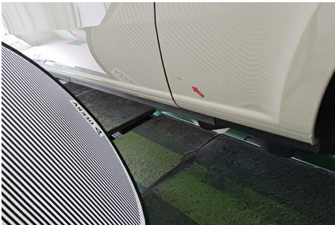
Bild 18 : Seitenteil hinten links, eingedellt, drücken
