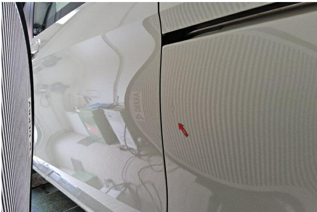
Bild 17 : Seitenteil hinten links, eingedellt, drücken
