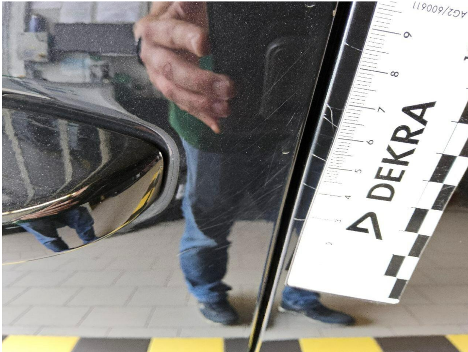
Bild 9 : Tür vorne links Lackierung, zerkratzt, polieren
