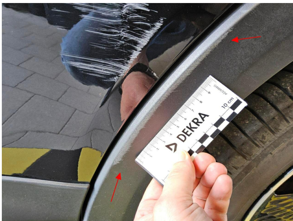
Bild 12 : Radlaufblende hinten links, verschrammt
