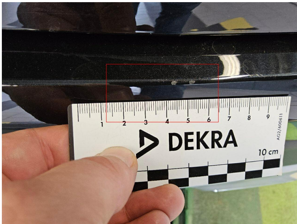
Bild 13 : Stoßfänger hinten, Kratzer
