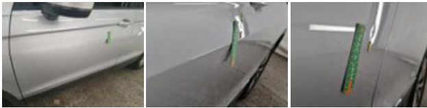
Porte ARG, Mauvaise réparation, Peindre
