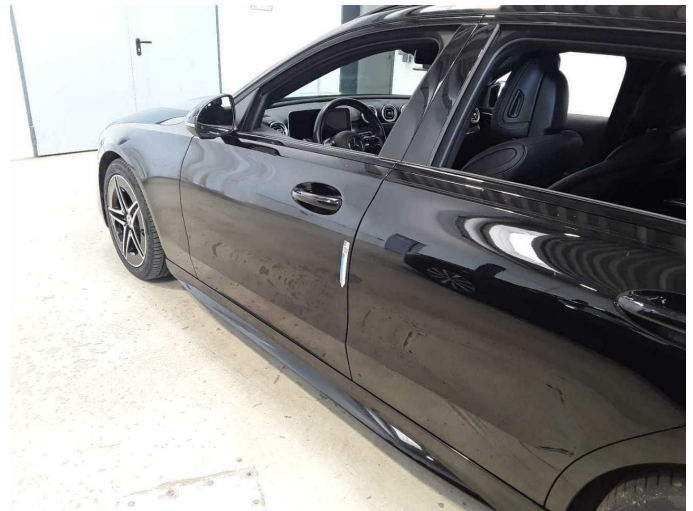
Damage 3: Door - front left side: Door edge - Scratch(es) - Smart repair
