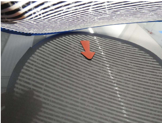
Motorhaube - Delle - entfernen
