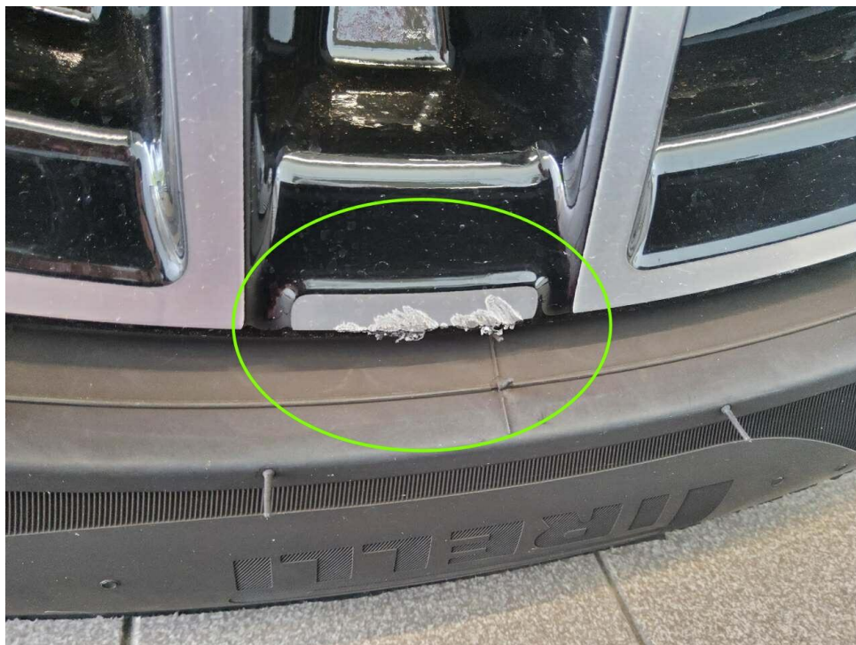
Bild 26 : Felge, hinten rechts, Lackierung, zerkratzt ( Minderwert )
