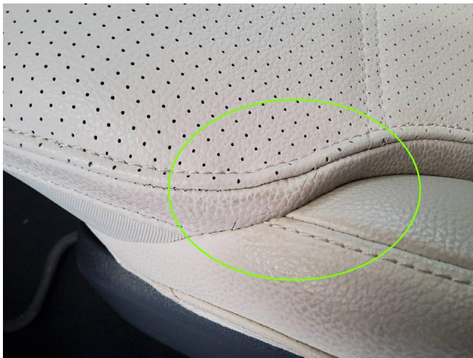
Bild 22 : Sitzbezug, Fahrersitz, verschrammt
