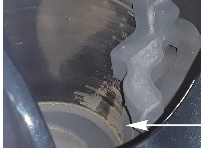
Damage 11: Braking system: Brake discs and brake pads - front (Scheiben sind stark eingelaufen) - Worn - Replace
