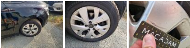
Alloy rim FL, Scratch(es), Repair/replace (lump sum)
