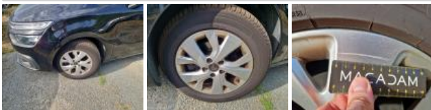
Alloy rim FL, Scratch(es), Repair/replace (lump sum)
