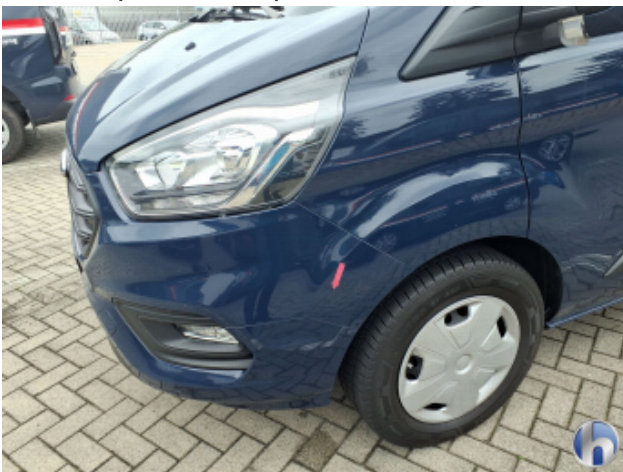
3. Stoßfänger Vorne Kratzer - Smart Repair
