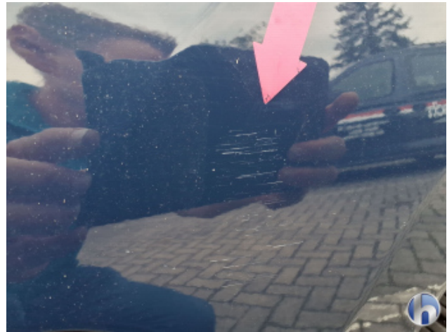
3. Stoßfänger Vorne Kratzer - Smart Repair
