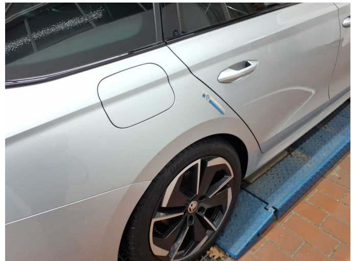
Damage 3: Side panel - rear right side: Side panel (Delle geht über die Kante) - dent(s) - Repair and paint
