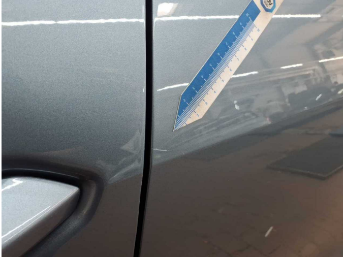
Damage 7: Door - rear left side: Door (Mit Delle) - Scratch(es) - Repair and paint
