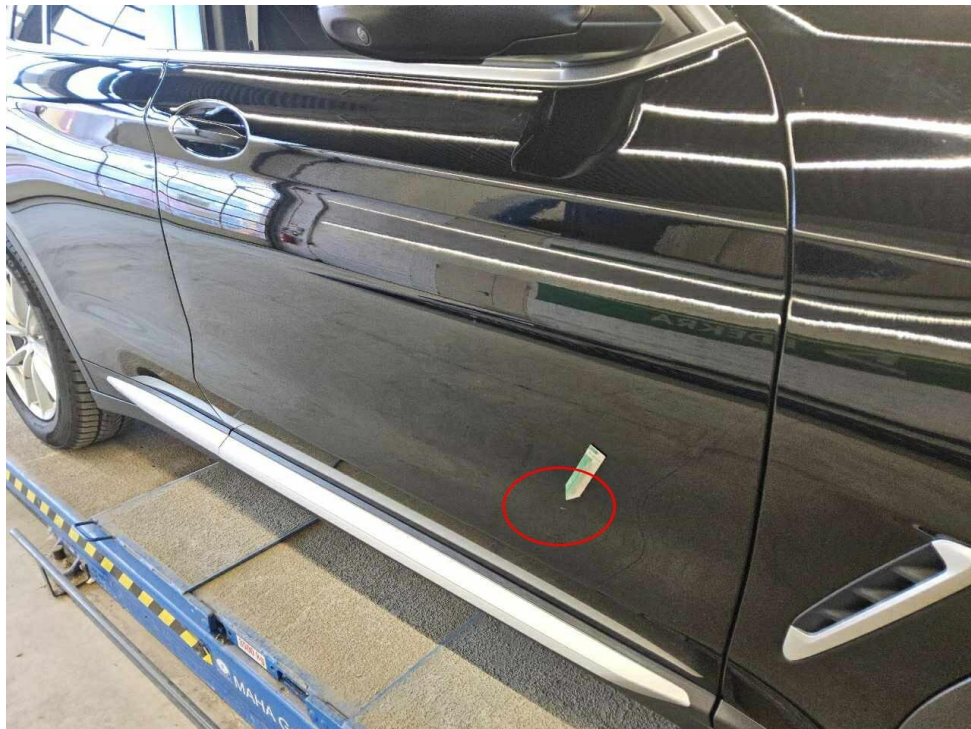
Bild 21 : Tür vorne rechts Lackierung, zerkratzt, smart repair
