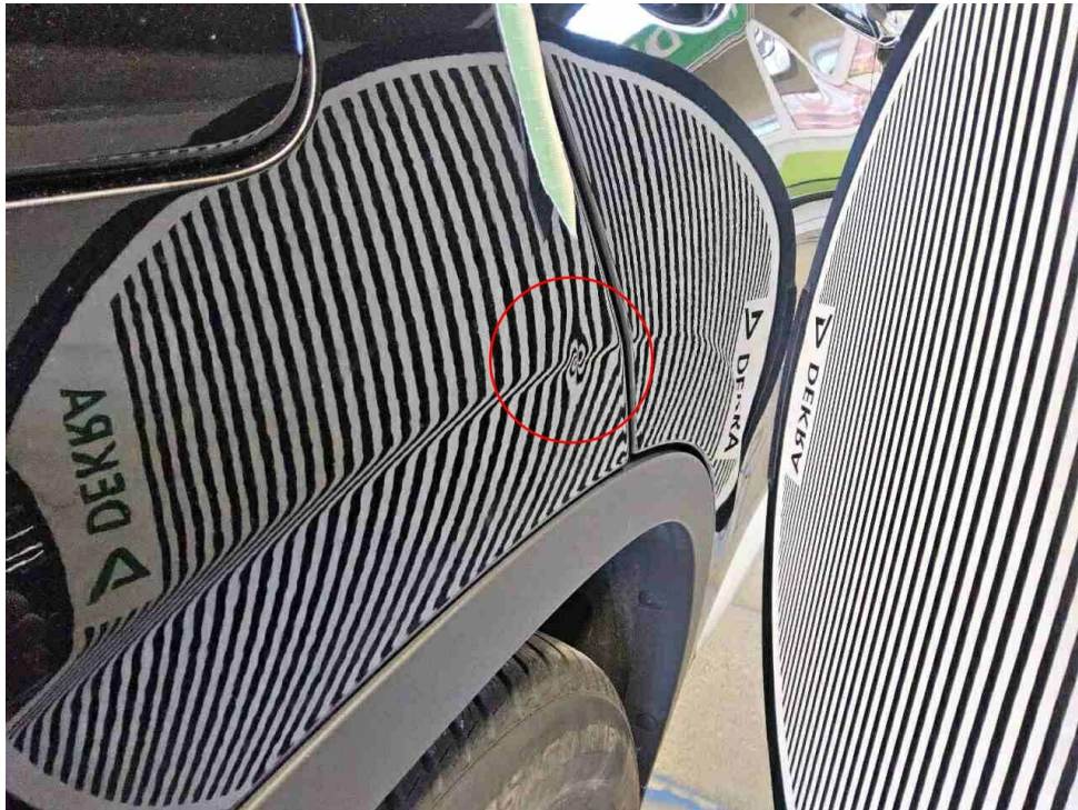
Bild 15 : Seitenteil hinten rechts, eingedellt, drücken
