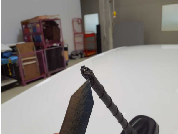
Beschädigung #1: Fahrzeugdach: Antennenstab - Marderschaden - erneuern
