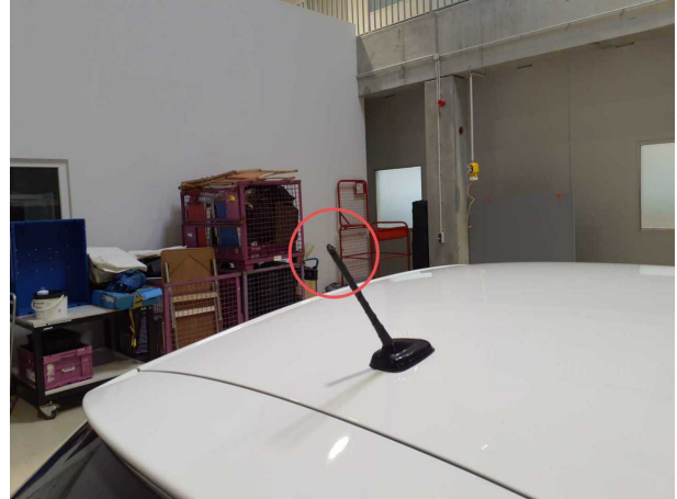
Beschädigung #1: Fahrzeugdach: Antennenstab - Marderschaden - erneuern
