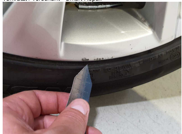
Beschädigung #4: Rad/Reifen: Leichtmetallfelge hinten links (Optischer Mangel) - verkratzt / verschürft - Smart Repair
