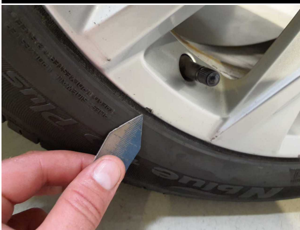
Beschädigung #4: Rad/Reifen: Leichtmetallfelge hinten links (Optischer Mangel) - verkratzt / verschürft - Smart Repair
