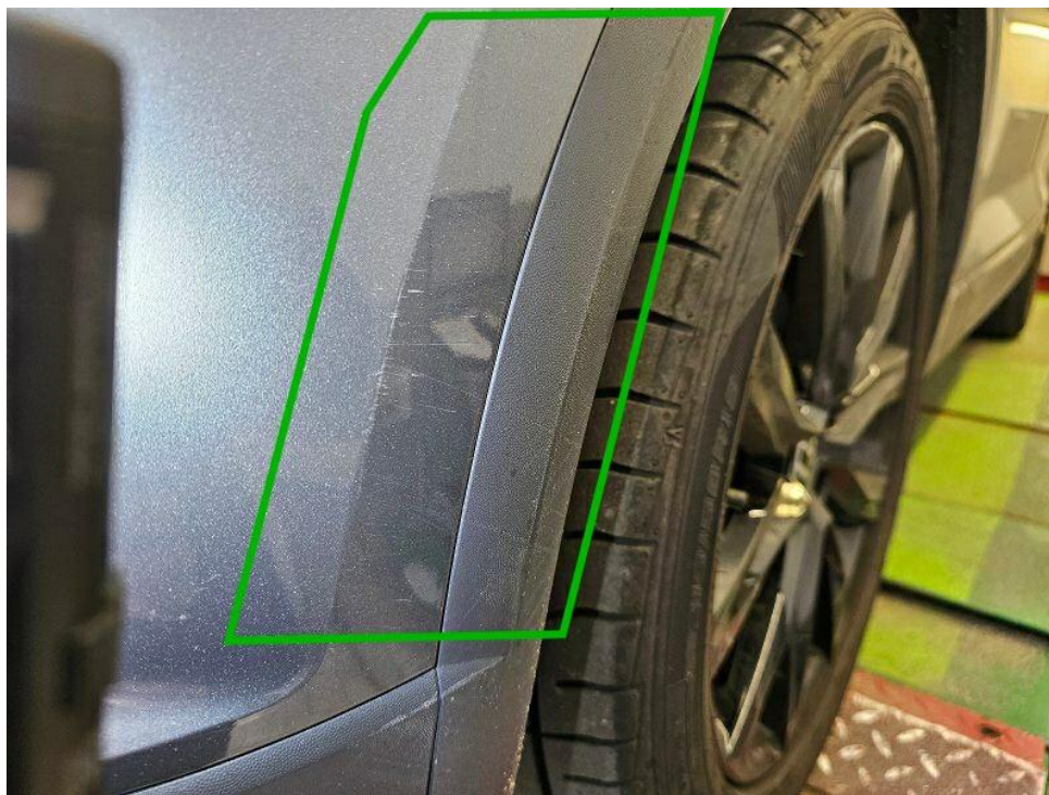
Bild 16 : Radlauf vorne links zerkratzt Stoßfängerverkleidung vorne zerkratzt
