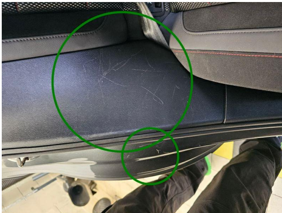
Bild 19 : Türeinstiegsverkleidung hinten rechts zerkratzt
