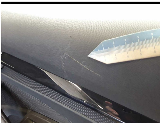
Beschädigung #6: Verkleidungen/Abdeckungen: Türverkleidung hinten rechts - Kratzer - erneuern
