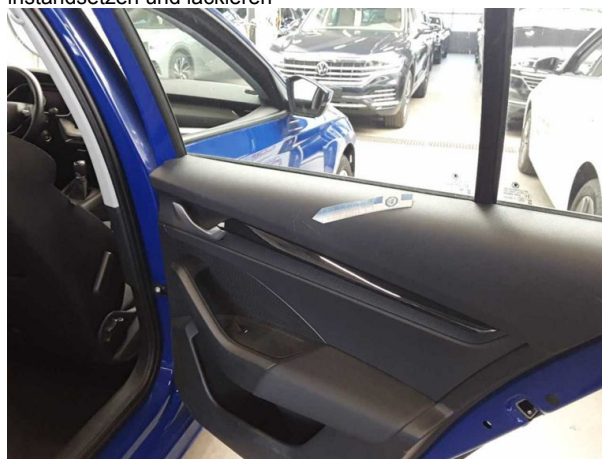
Beschädigung #6: Verkleidungen/Abdeckungen: Türverkleidung hinten rechts - Kratzer - erneuern
