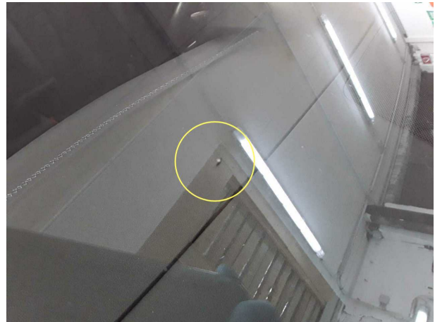
Beschädigung #4: Verglasung: Frontscheibe (Rissbildung) - Steinschlag - erneuern
