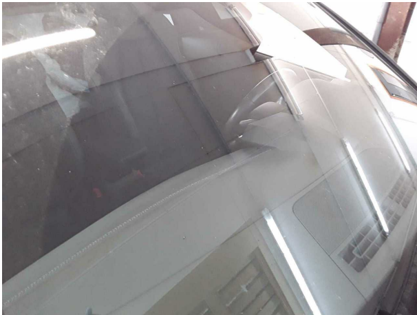
Beschädigung #4: Verglasung: Frontscheibe (Rissbildung) - Steinschlag - erneuern
