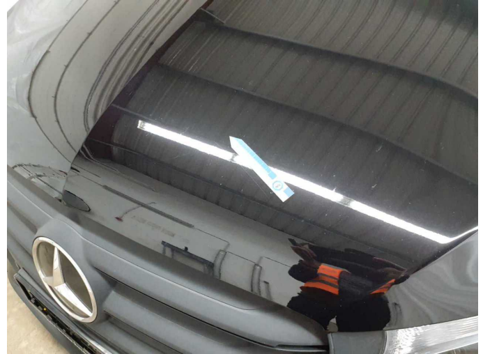
Damage 14: Bonnet: Bonnet (Anätzung/Kratzer) - Paint defect - Repair and paint
