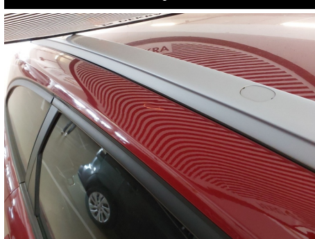
Dachholm / Rechts / Hagelschaden
