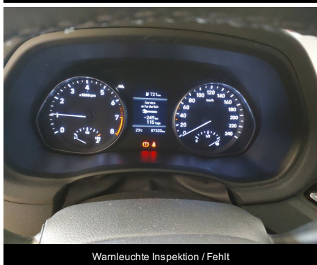
Warnleuchte Inspektion / Fehlt
