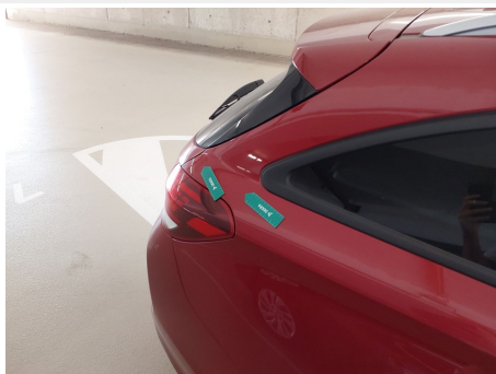
Kotflügel / Hinten Rechts / Hagelschaden
