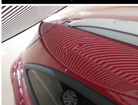
Dachholm / Rechts / Hagelschaden
