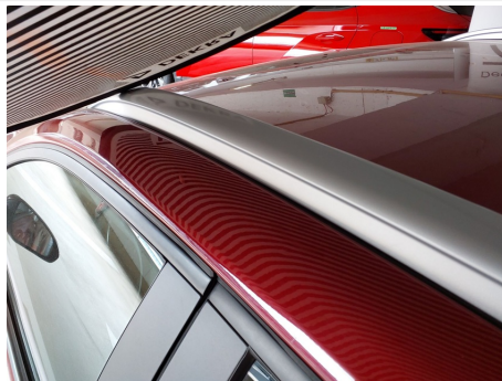
Dachholm / Links / Hagelschaden
