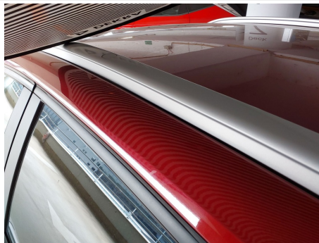
Dachholm / Links / Hagelschaden
