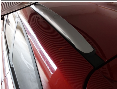
Dachholm / Links / Hagelschaden
