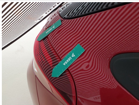
Kotflügel / Hinten Rechts / Hagelschaden
