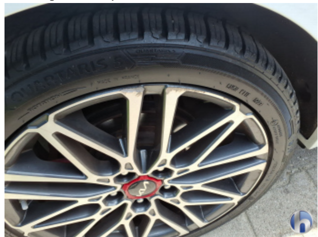
6. Felge Hinten - Rechts Beschädigt - Smart Repair
