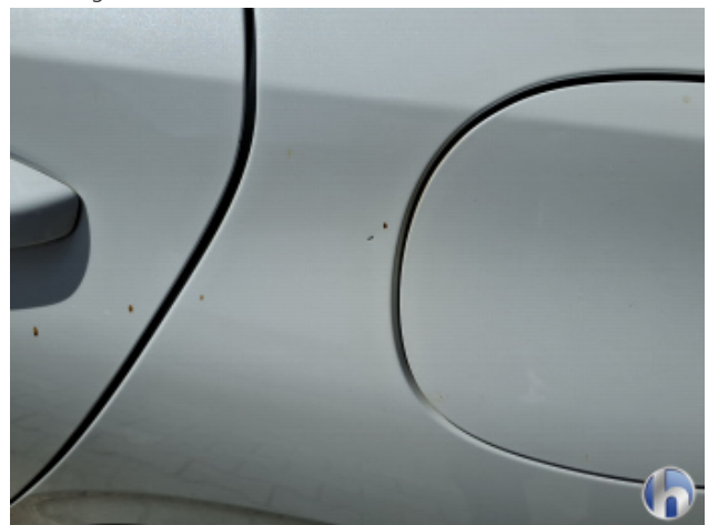
2. Seitenwand - Hinten - Links Steinschlag - Smart Repair
