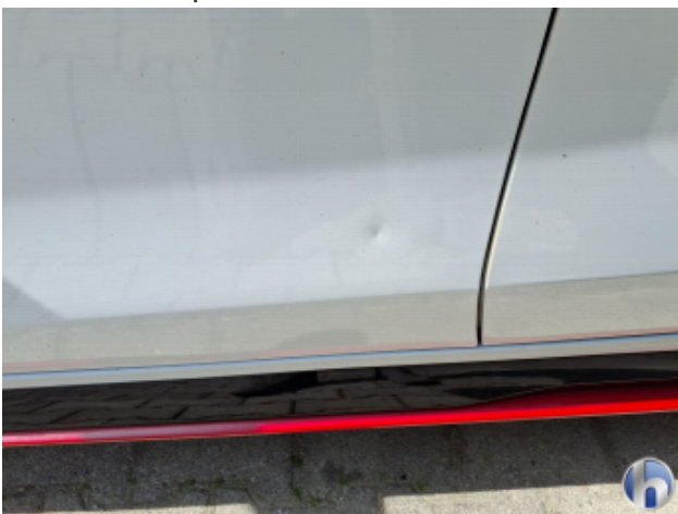
7. Tür Vorne - Links Verdellt - Sanft Instandsetzen
