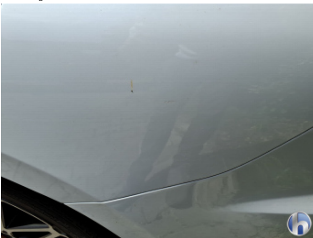
1. Seitenwand - Hinten - Links Kratzer - Smart Repair
