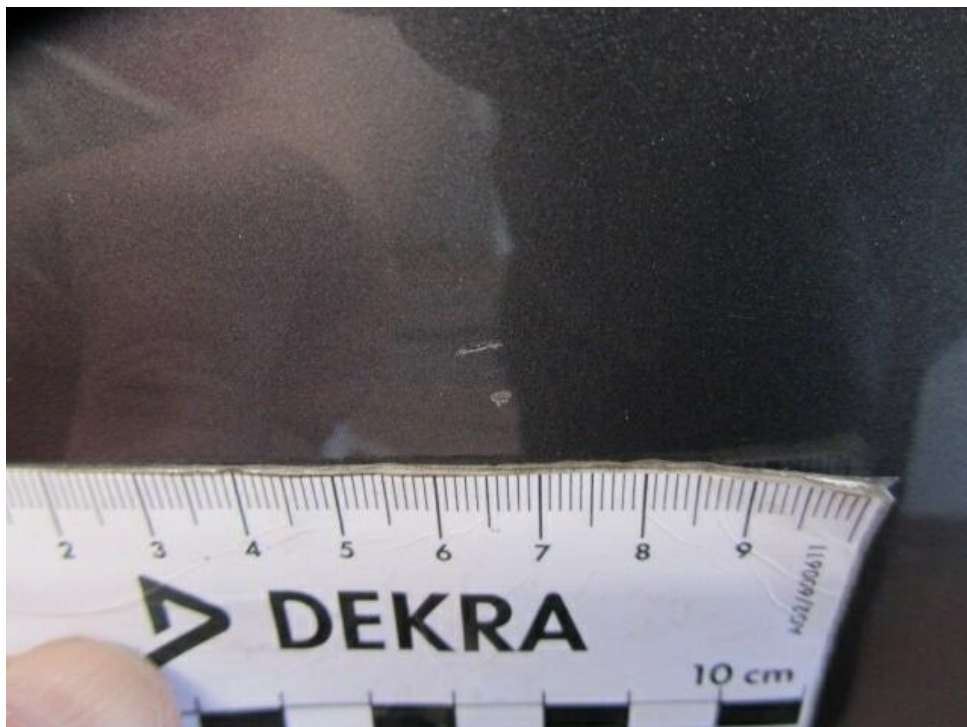
Bild 14 : Tür hinten rechts Lackierung, verschrammt, lackieren mit Lackaufbau
