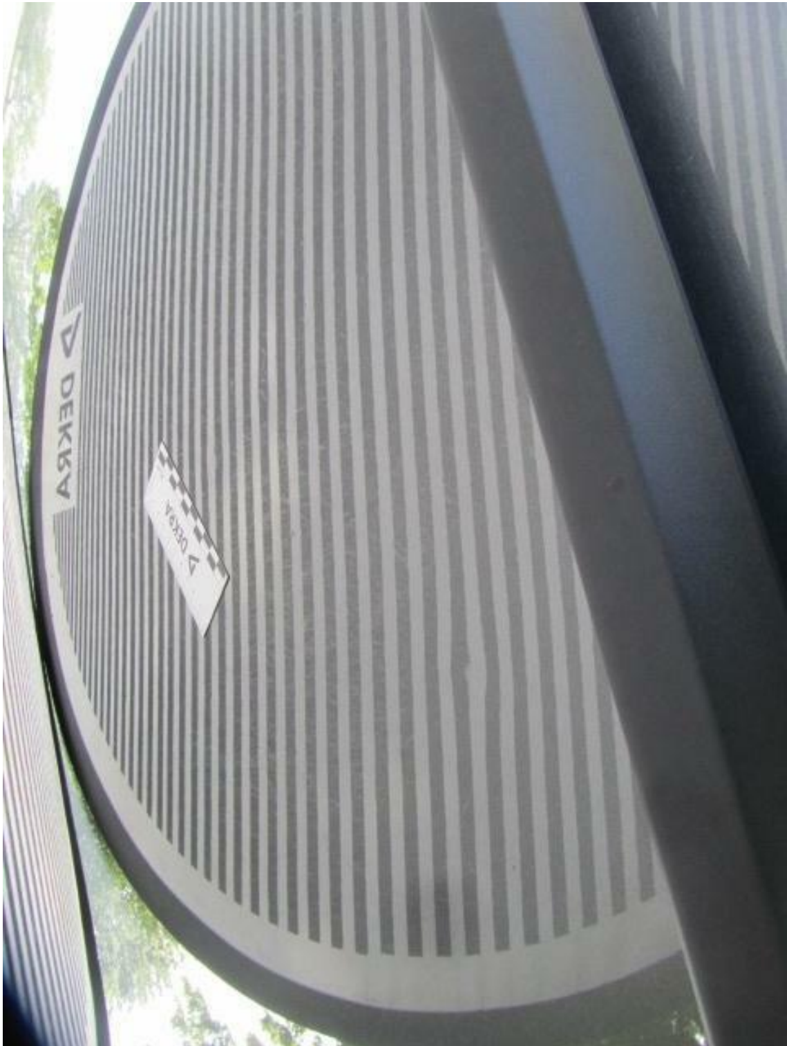
Bild 17 : Fz. mit Hagelschaden Dach mit Holmen, Heckklappe mit Spoiler ggf. GA anfordern
