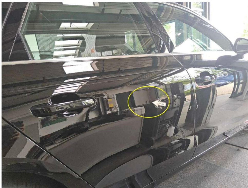
Bild 16 : Tür hinten rechts, eingedellt, drücken
