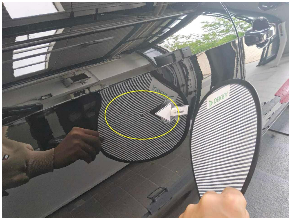
Bild 17 : Tür hinten rechts, eingedellt, drücken
