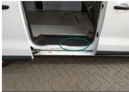
Dichtung Türeinstieg / Rechts / Abgewetzt
