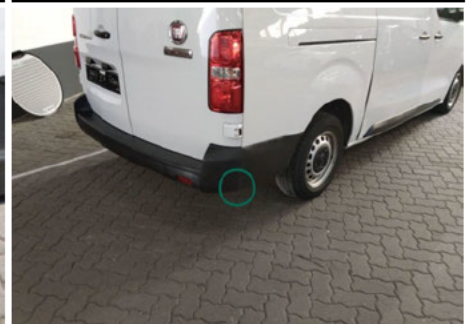
Stoßfänger / Hinten Rechts / Gebrochen
