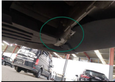
Heckblech / Hinten / Delle
