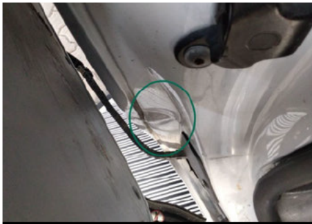
Säule / Rechts / Delle
