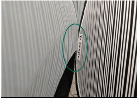
Kotflügel / Vorne Rechts / Delle
