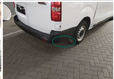
Abdeckung / Unten Hinten Rechts / Gebrochen
