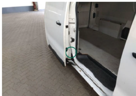
Säule / Rechts / Delle
