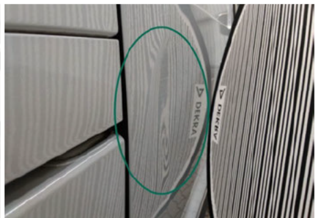
Tür / Rechts / Delle
