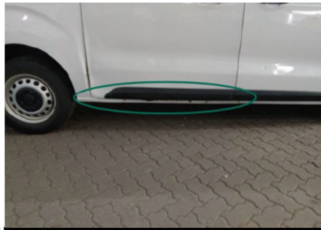
Schweller / Rechts / Delle
