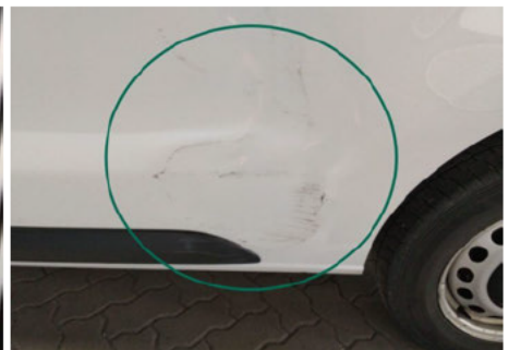
Seitenwand / Unten Links / Delle
