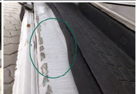
Türeinstieg / Rechts / Delle
