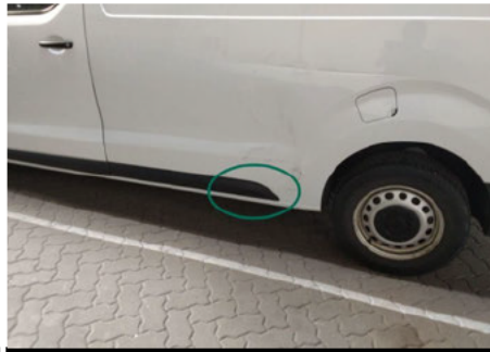
Zierleiste Seitenwand / Links / Kratzer
