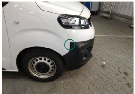
Stoßfängerhalter / Vorne Rechts / Nicht konform
