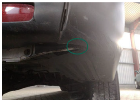
Stoßfänger / Hinten Rechts / Gebrochen
