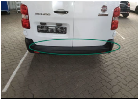
Stoßfänger / Hinten / Kratzer
