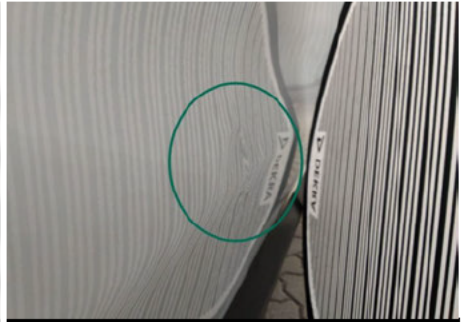
Tür / Rechts / Delle
