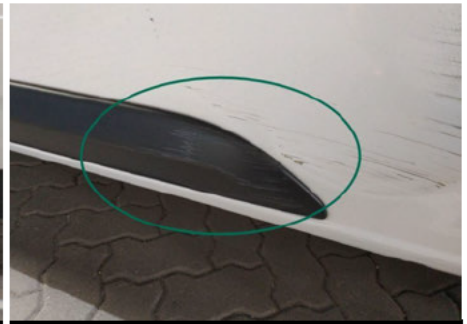
Zierleiste Seitenwand / Links / Kratzer
