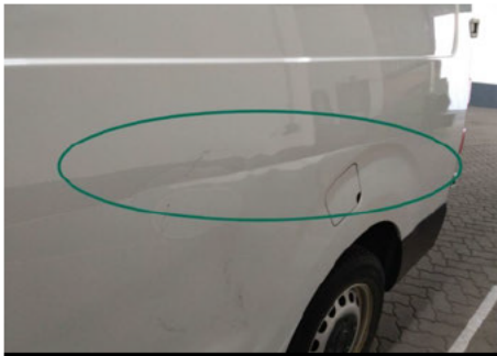
Seitenwand / Unten Links / Delle
