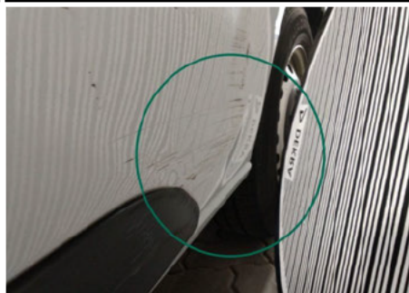
Seitenwand / Unten Links / Delle
