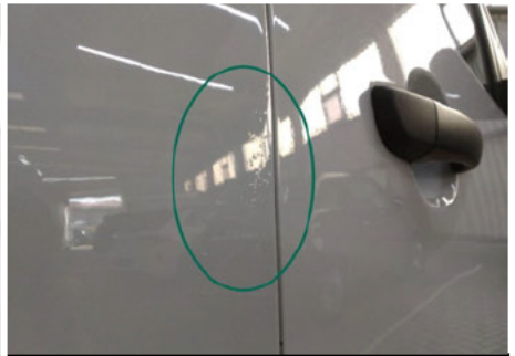
Tür / Rechts / Delle
