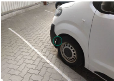
Radhausschale / Vorne Links / Abgewetzt
