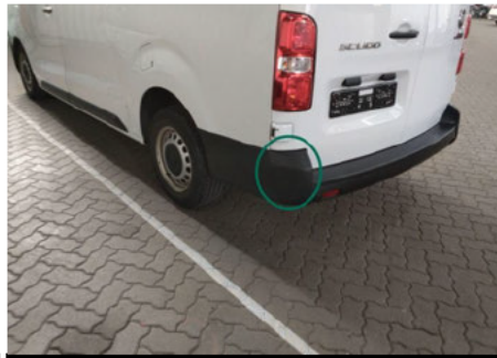
Stoßfänger / Hinten Links / Kratzer
