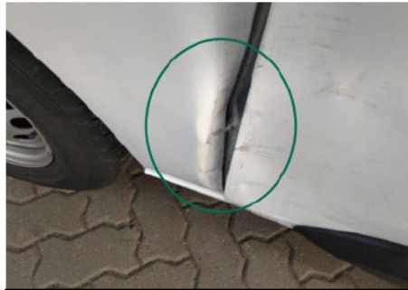
Seitenwand / Unten Rechts / Delle
