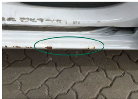
Schweller / Rechts / Delle
