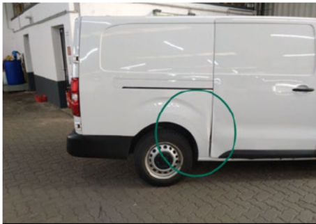
Seitenwand / Unten Rechts / Delle
