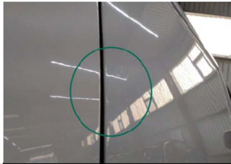
Tür / Rechts / Delle
