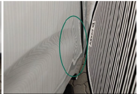
Seitenwand / Unten Rechts / Delle
