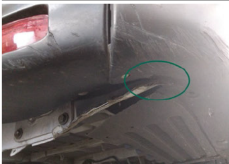
Stoßfänger / Hinten Rechts / Gebrochen
