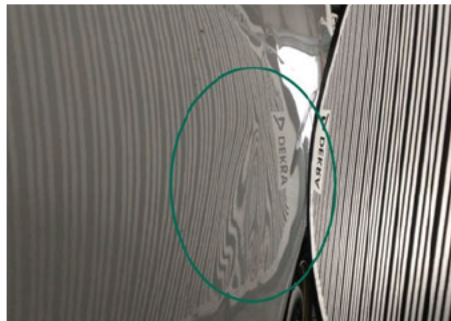
Seitenwand / Unten Links / Delle
