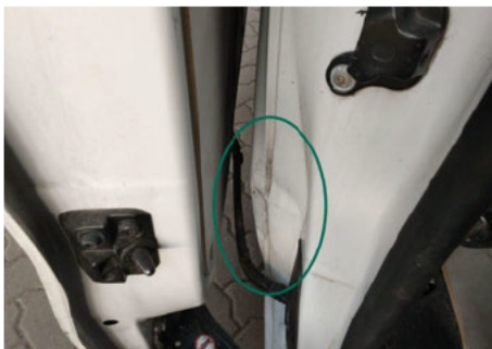
Seitenwand / Unten Rechts / Delle
