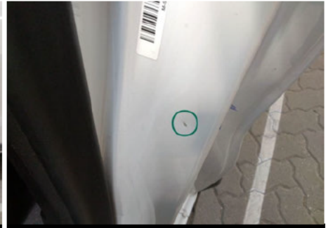
Säule / Vorne Links / Delle
