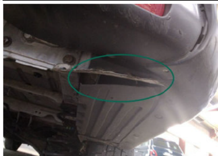
Abdeckung / Unten Hinten Rechts / Gebrochen
