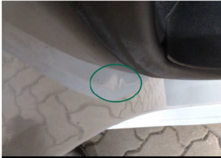
Säule / Vorne Rechts / Delle
