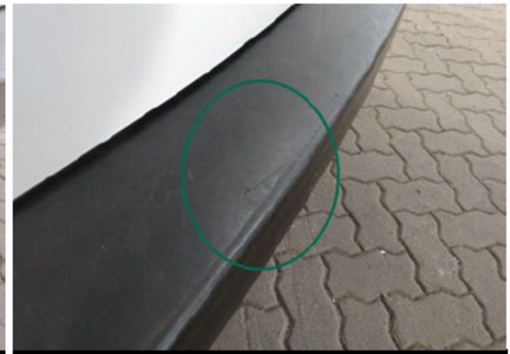
Stoßfänger / Hinten / Kratzer
