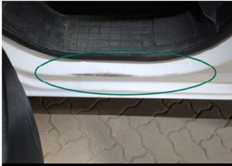
Türeinstieg / Vorne Links / Abgewetzt
