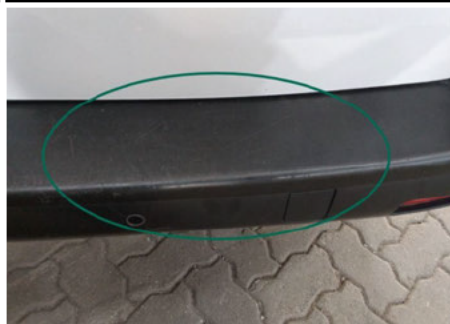
Stoßfänger / Hinten / Kratzer
