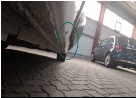
Schweller / Rechts / Delle
