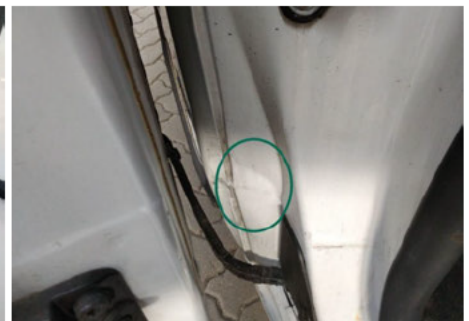
Säule / Rechts / Delle
