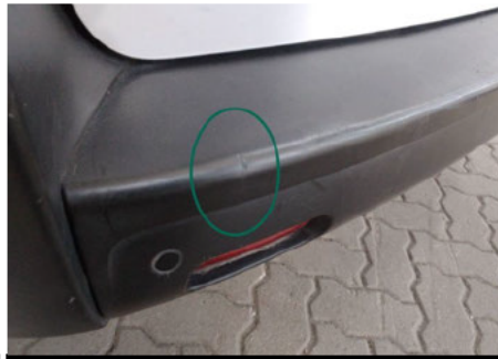
Stoßfänger / Hinten / Kratzer
