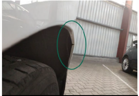
Kotflügel / Vorne Rechts / Delle
