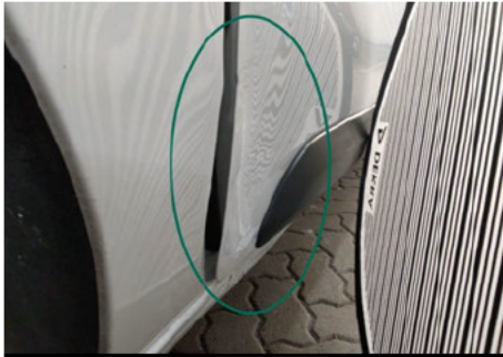
Tür / Rechts / Delle
