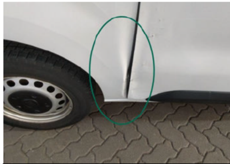
Seitenwand / Unten Rechts / Delle
