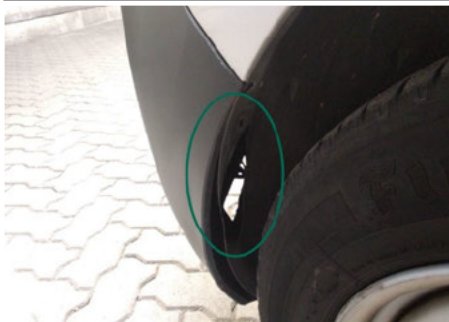
Radhausschale / Vorne Links / Abgewetzt
