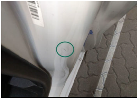
Säule / Vorne Links / Delle
