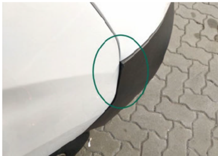
Stoßfängerhalter / Vorne Rechts / Nicht konform
