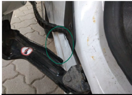
Schweller / Rechts / Delle
