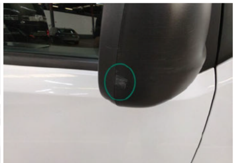
Außenspiegelkappe / Rechts / Kratzer
