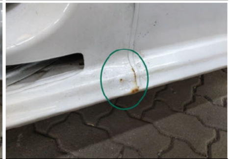
Schweller / Rechts / Delle
