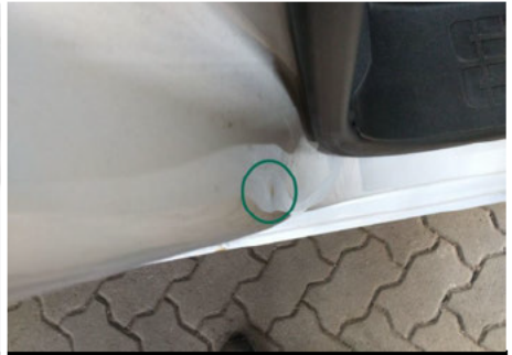
Säule / Vorne Rechts / Delle
