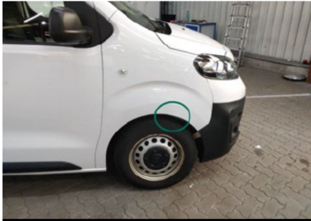
Kotflügel / Vorne Rechts / Delle
