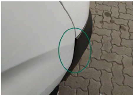
Stoßfängerhalter / Vorne Rechts / Nicht konform
