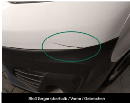
Stoßfänger oberhalb / Vorne / Gebrochen
