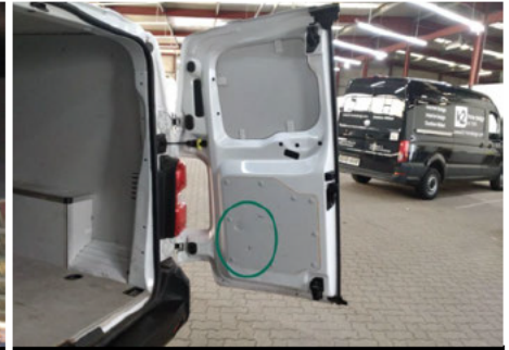
Innenverkleidung Laderaum / Unten Hinten Rechts / Gebrochen
