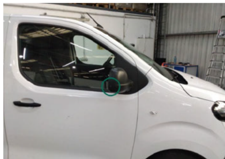
Außenspiegelkappe / Rechts / Kratzer
