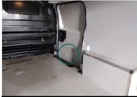
Innenverkleidung Laderaum / Unten Vorne Rechts / Gebrochen
