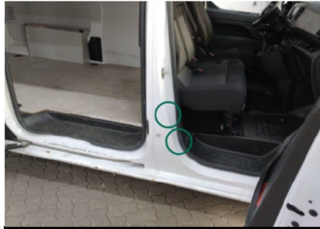
Säule / Vorne Rechts / Delle
