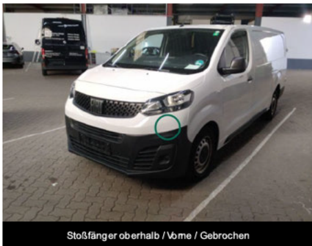
Stoßfänger oberhalb / Vorne / Gebrochen
