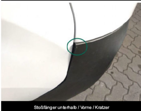
Stoßfänger unterhalb / Vorne / Kratzer
