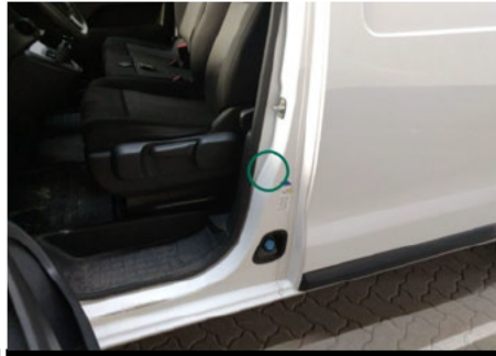
Säule / Vorne Links / Delle
