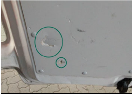
Innenverkleidung Laderaum / Unten Hinten Rechts / Gebrochen
