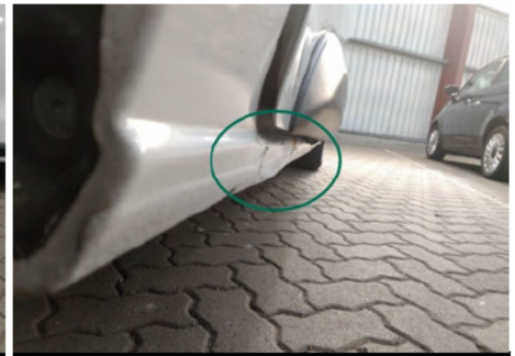
Schweller / Rechts / Delle
