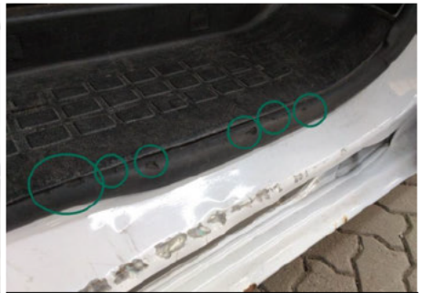
Dichtung Türeinstieg / Rechts / Abgewetzt
