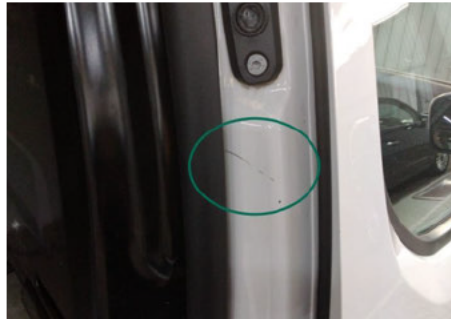
Säule / Oben Rechts / Kratzer
