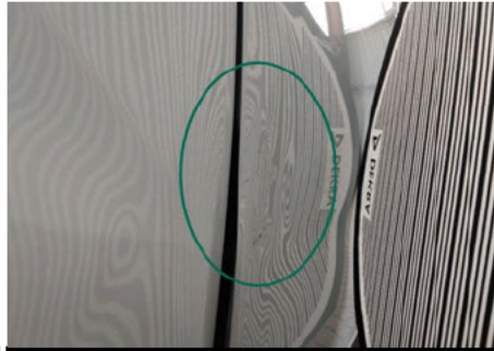
Tür / Rechts / Delle
