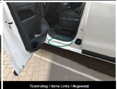
Türeinstieg / Vorne Links / Abgewetzt
