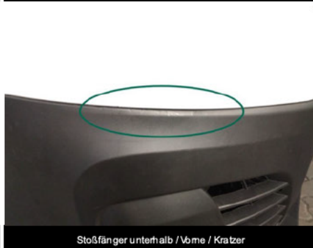
Stoßfänger unterhalb / Vorne / Kratzer
