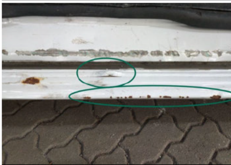
Schweller / Rechts / Delle
