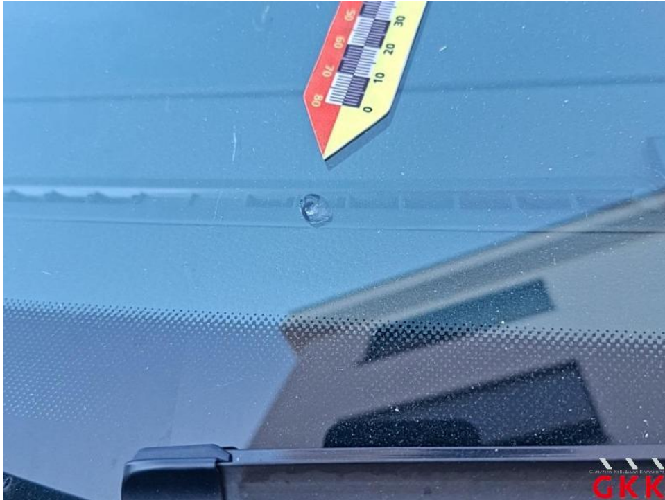
Bild 19. Frontscheibe, Steinschlag, ersetzen
