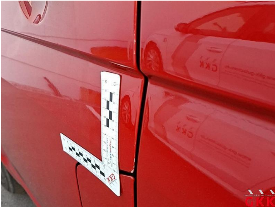
Bild 55. Tür vorne links, Kante, beschädigt, auslegen, schleifen, polieren
