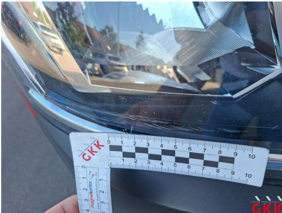
Bild 45. Scheinwerfer links Halogen, beschädigt, ersetzen
