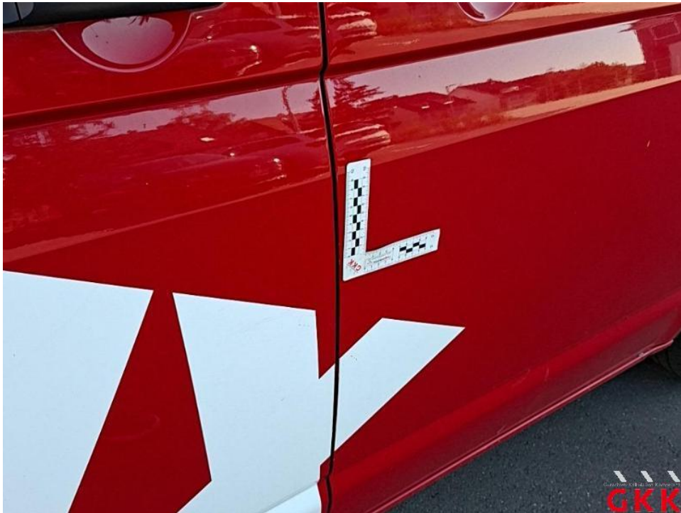
Bild 56. Tür vorne rechts, Kante, beschädigt, auslegen, schleifen, polieren
