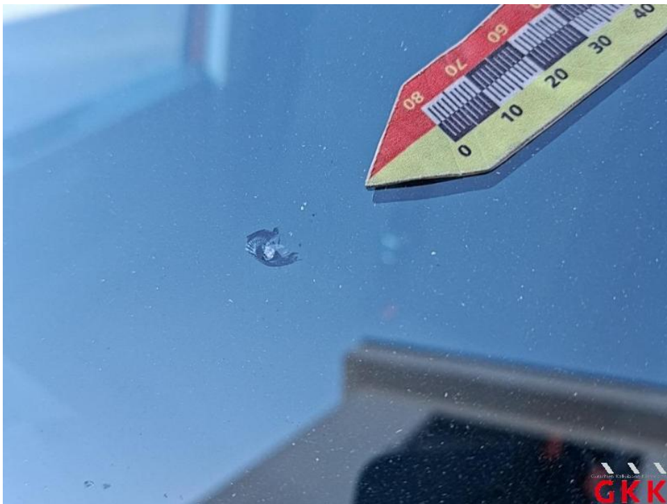
Bild 20. Frontscheibe, Steinschlag, ersetzen
