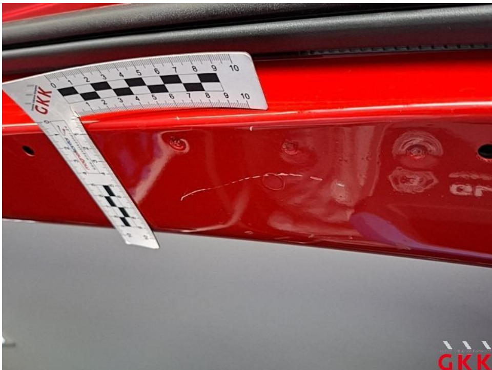
Bild 30. Dach, innen, verkratzt, Smartrepair
