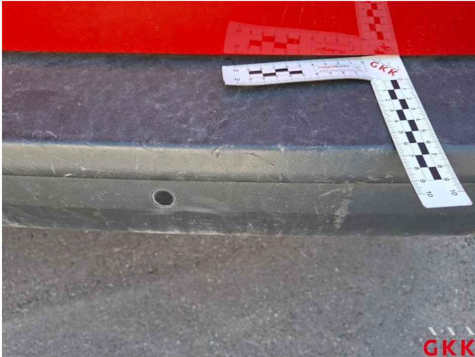
Bild 47. Stoßfänger hinten, Verkleidung -unlackiert-, beschädigt, ersetzen
