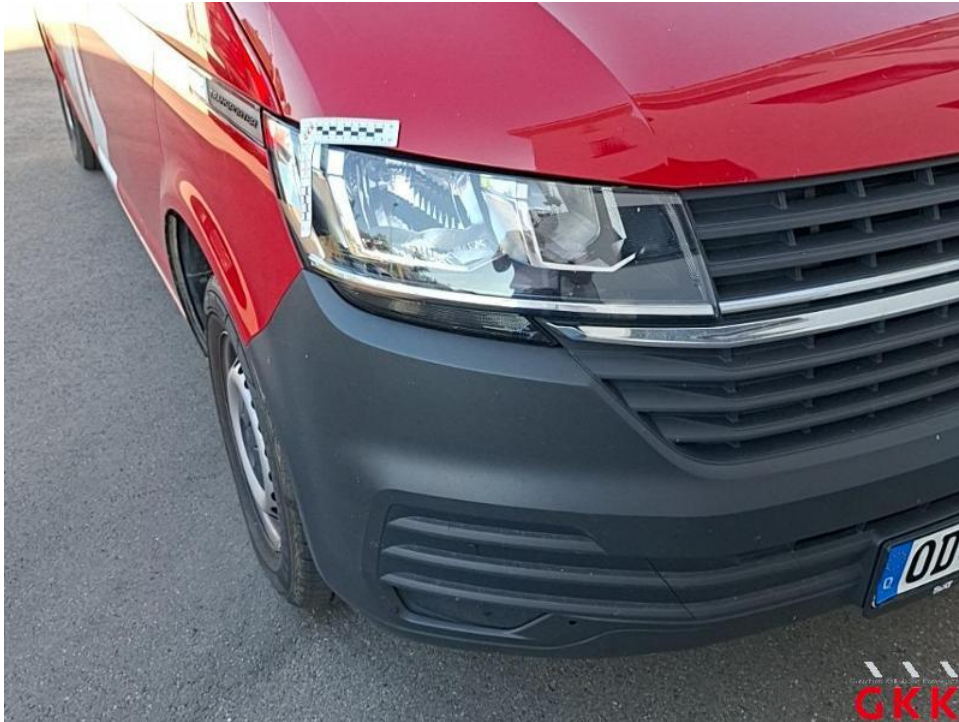
Bild 43. Scheinwerfer links Halogen, beschädigt, ersetzen
