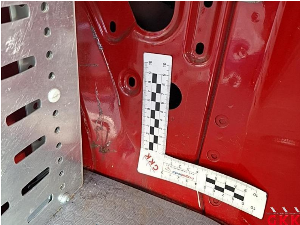
Bild 34. Seitenwand rechts, innen, verkratzt, Spotlackieren
