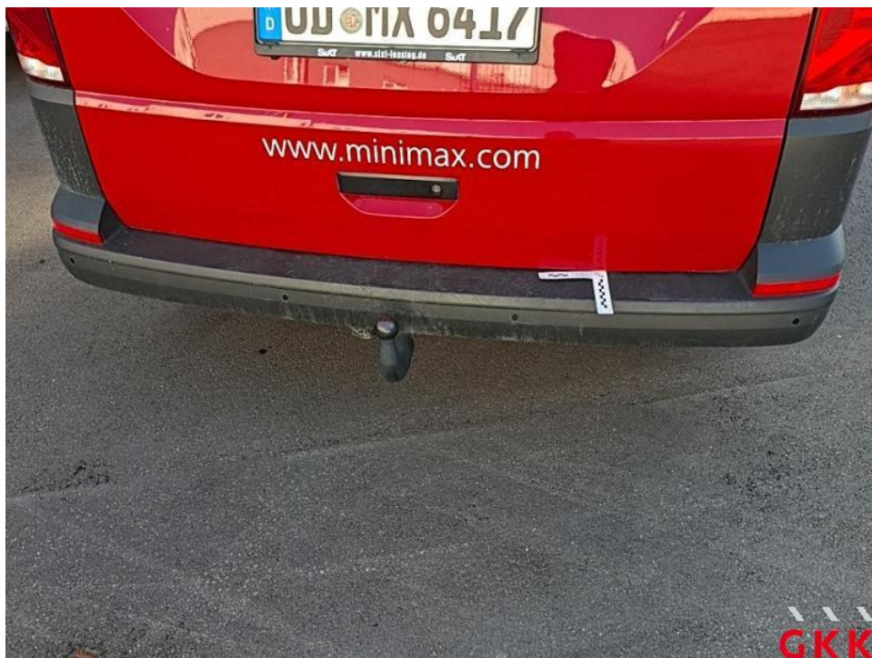
Bild 46. Stoßfänger hinten, Verkleidung -unlackiert-, beschädigt, ersetzen
