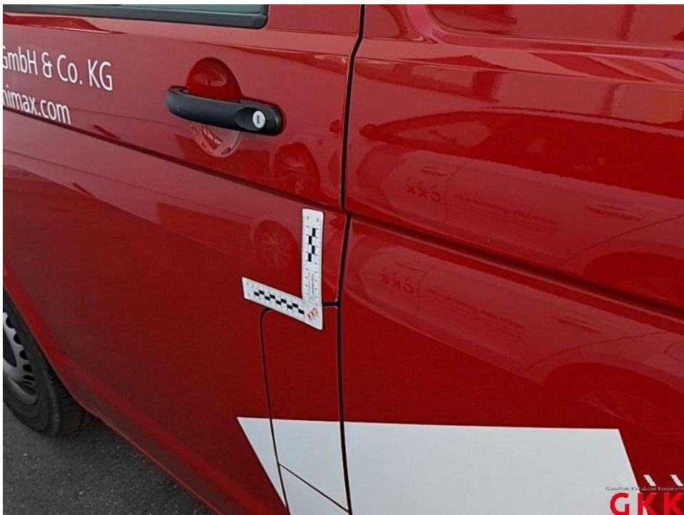
Bild 54. Tür vorne links, Kante, beschädigt, auslegen, schleifen, polieren
