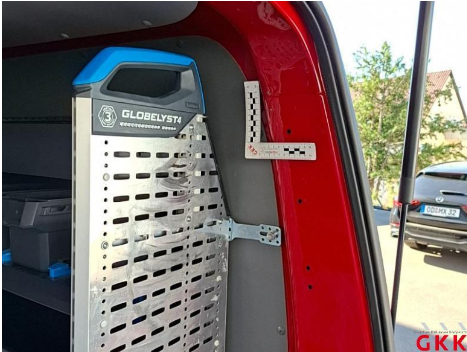
Bild 27. D- Säule rechts, verkratzt, lackieren
