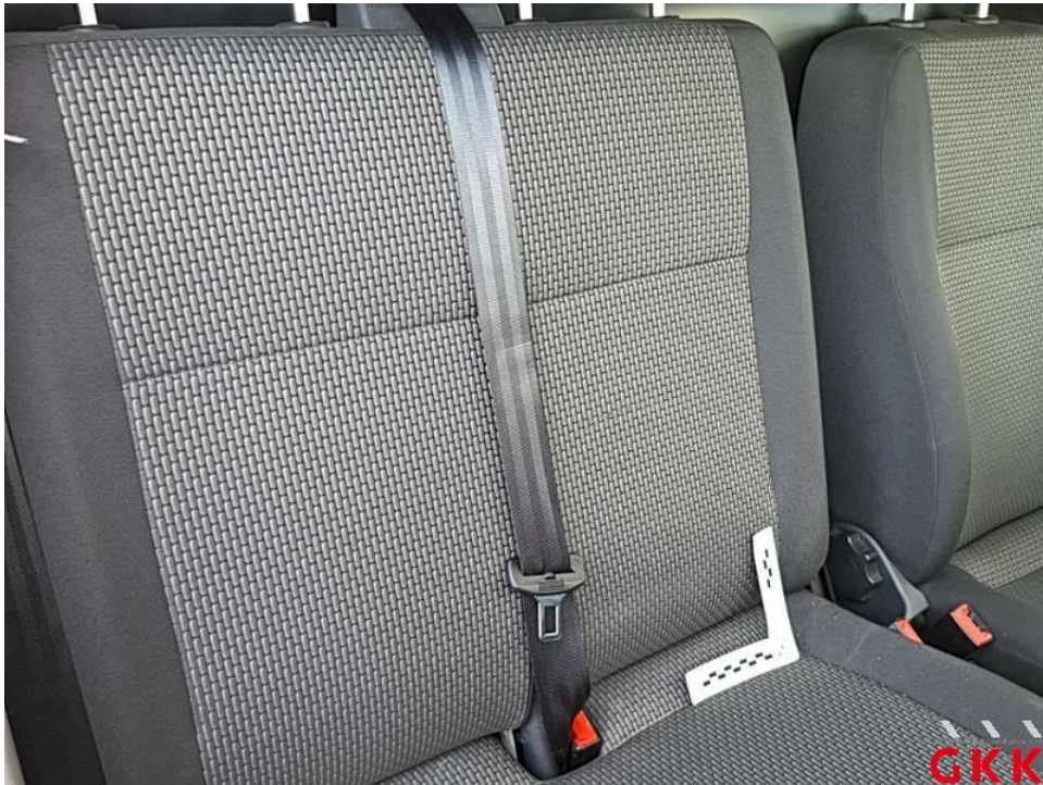
Bild 16. Sitz vorne rechts, Bezug Rückenlehne -Stoff-, beschädigt, ersetzen
