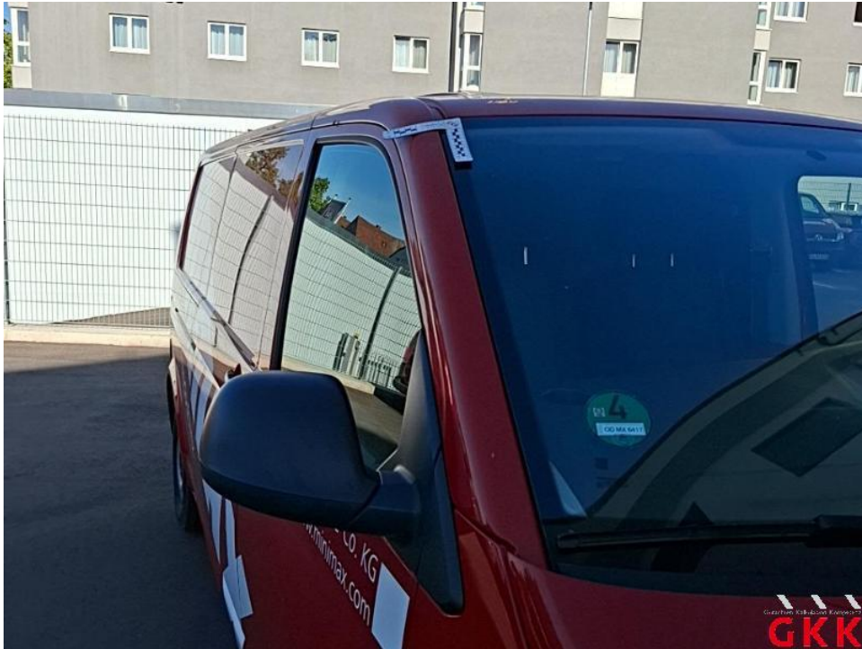
Bild 35. A- Säule rechts, beschädigt, instand setzen - lackieren
