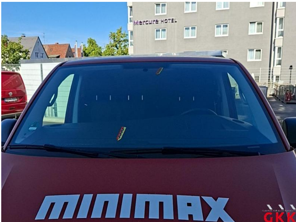
Bild 18. Frontscheibe, Steinschlag, ersetzen
