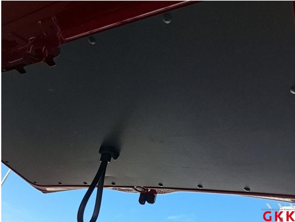
Bild 21. Heckklappe, Innenverkleidung, beschädigt, ersetzen
