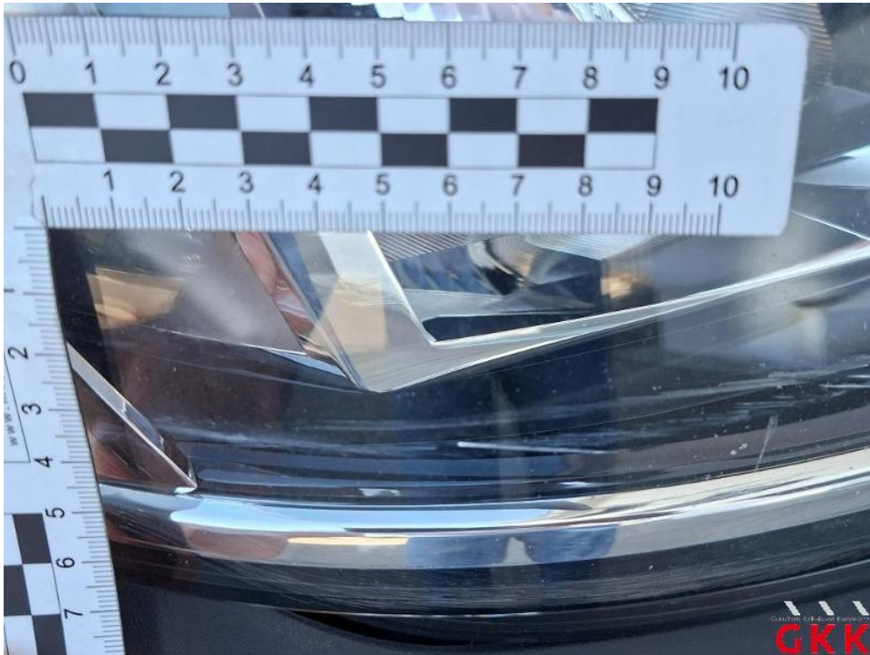
Bild 44. Scheinwerfer links Halogen, beschädigt, ersetzen
