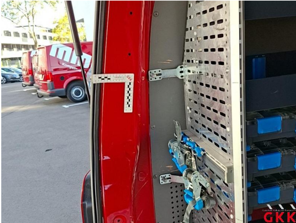
Bild 25. D- Säule links, verkratzt, lackieren
