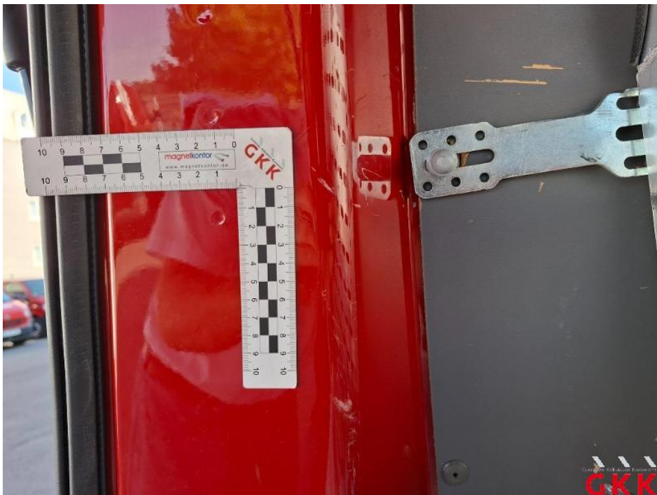
Bild 26. D- Säule links, verkratzt, lackieren
