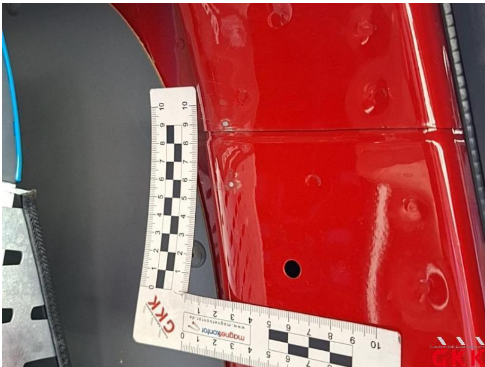
Bild 28. D- Säule rechts, verkratzt, lackieren
