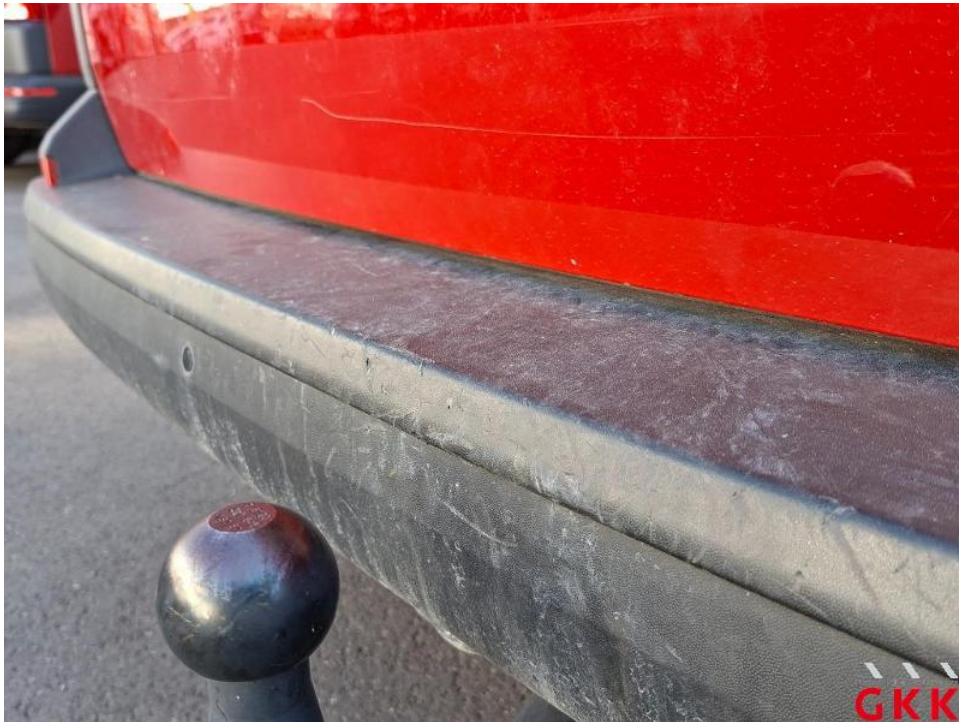
Bild 48. Stoßfänger hinten, Verkleidung -unlackiert-, beschädigt, ersetzen
