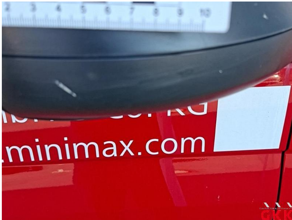
Bild 39. Spiegelgehäuse rechts, Blende -unlackiert-, verkratzt, ersetzen
