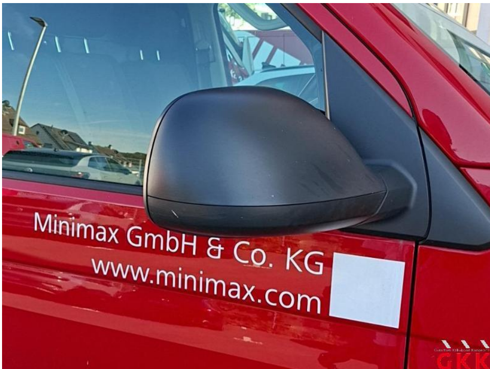
Bild 38. Spiegelgehäuse rechts, Blende -unlackiert-, verkratzt, ersetzen
