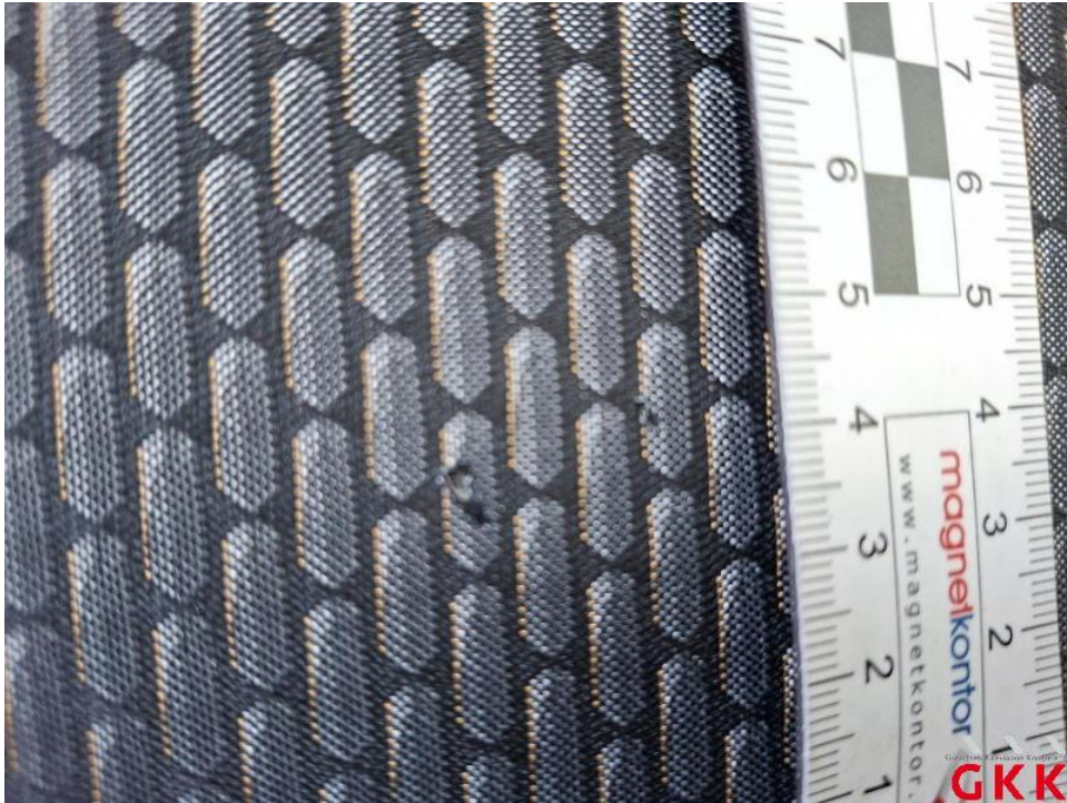
Bild 17. Sitz vorne rechts, Bezug Rückenlehne -Stoff-, beschädigt, ersetzen
