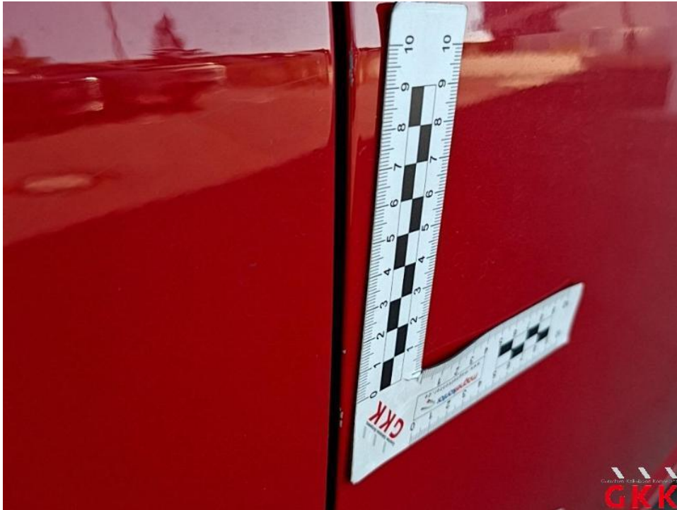
Bild 57. Tür vorne rechts, Kante, beschädigt, auslegen, schleifen, polieren
