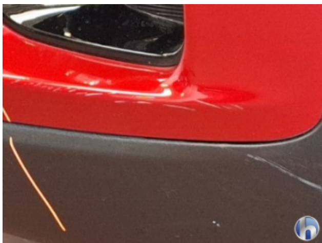
1. Stoßfänger Vorne Kratzer - Smart Repair
