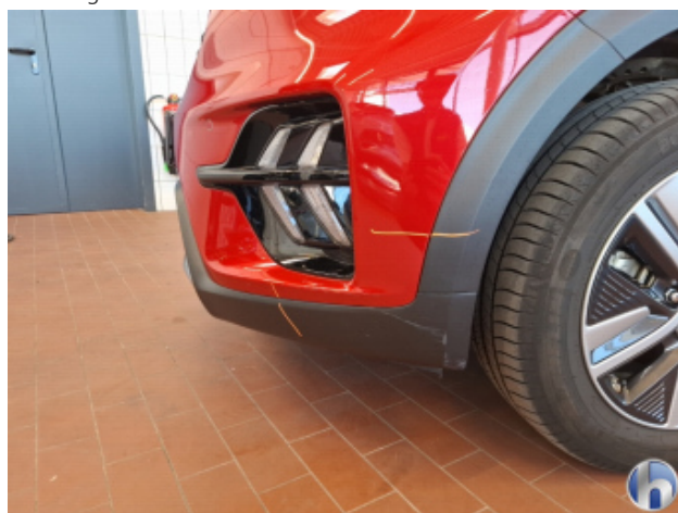
1. Stoßfänger Vorne Kratzer - Smart Repair
