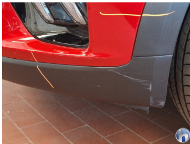
2. Frontspoiler Abschürfung - Smart Repair
