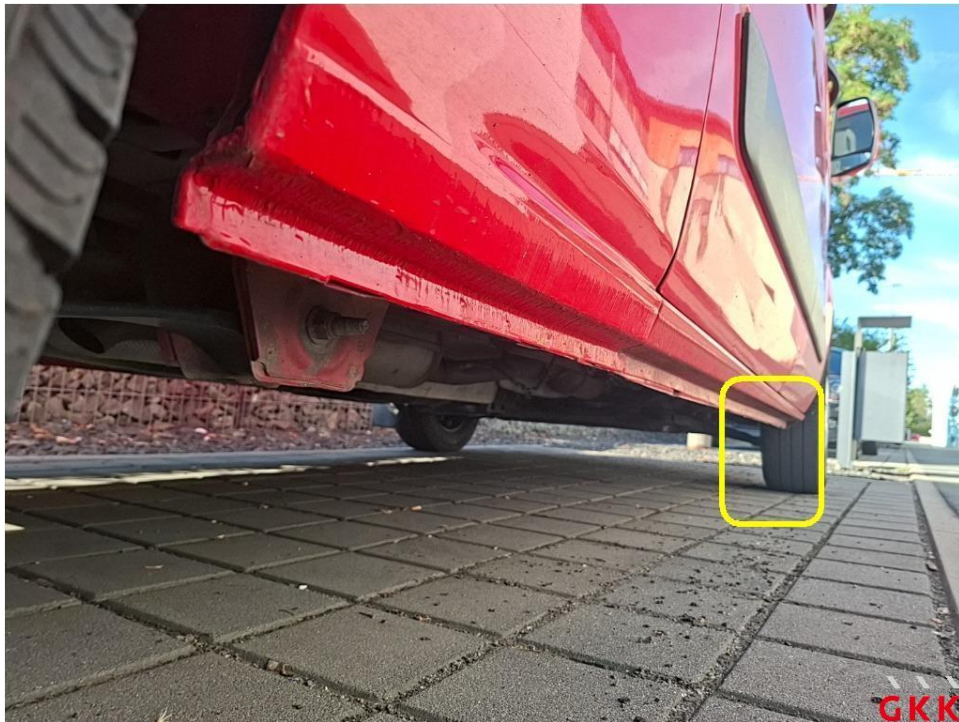
Bild 38. Kotflügel vorne rechts, Schmutzfänger, fehlt, ersetzen
