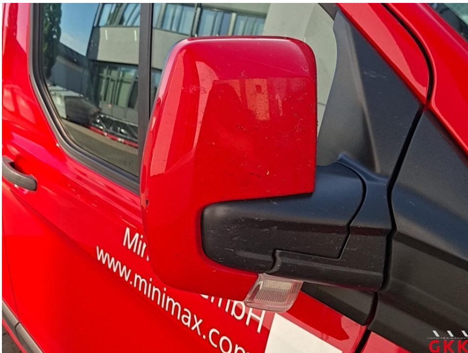
Bild 26. Spiegelgehäuse rechts, Kappe -lackiert-, verkratzt, lackieren
