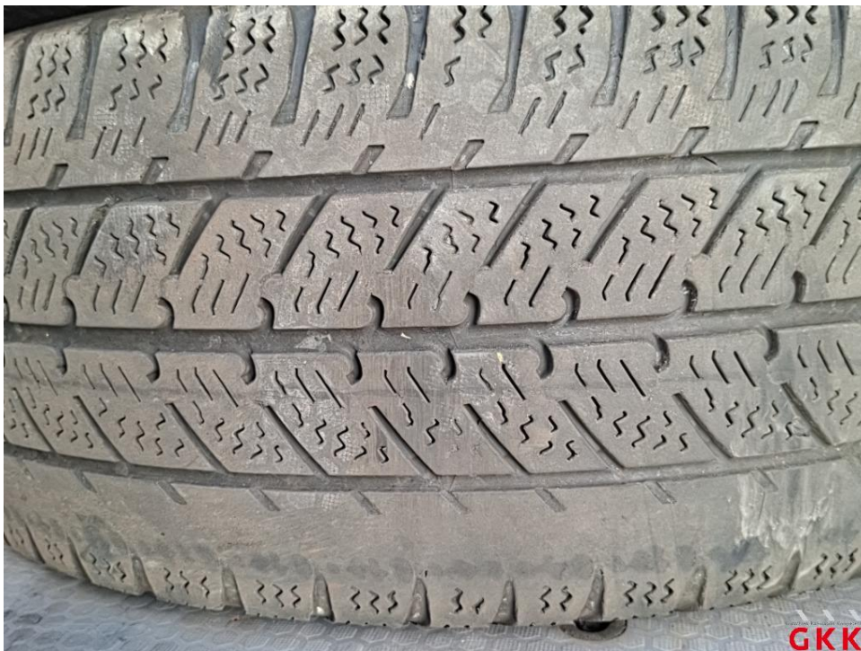
Bild 14. Reifen, 2 x beiliegend, Untermaß, ersetzen
