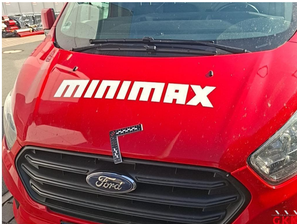
Bild 15. Motorhaube, bis 3 Dellen / Bauteil, kalt drücken
