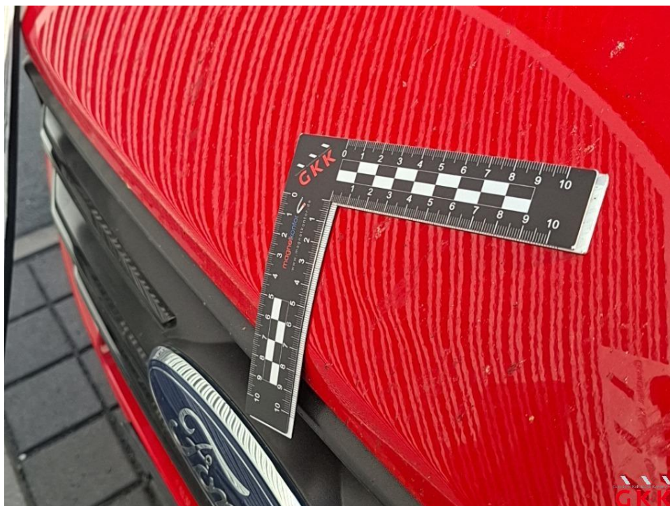
Bild 16. Motorhaube, bis 3 Dellen / Bauteil, kalt drücken
