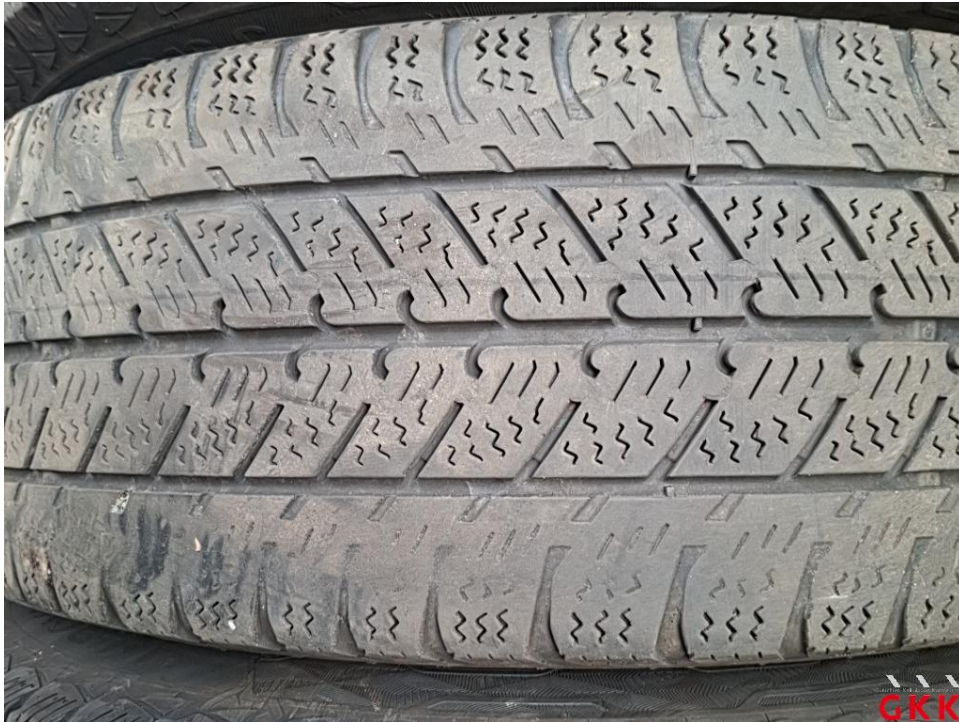
Bild 13. Reifen, 2 x beiliegend, Untermaß, ersetzen
