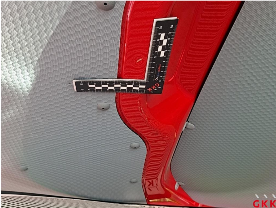
Bild 19. Heckklappe, innen, beschädigt, Smartrepair
