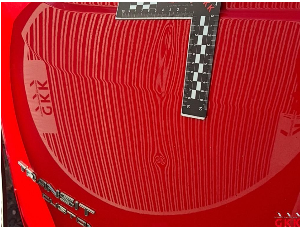
Bild 36. Heckklappe, beschädigt, instand setzen - lackieren
