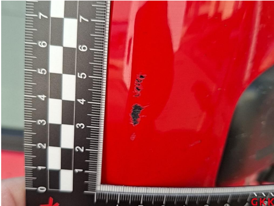
Bild 27. Spiegelgehäuse rechts, Kappe -lackiert-, verkratzt, lackieren
