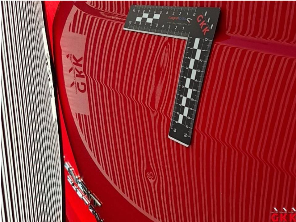
Bild 37. Heckklappe, beschädigt, instand setzen - lackieren
