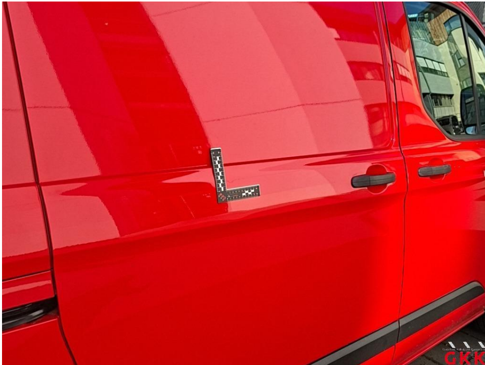
Bild 22. Schiebetür rechts, bis 3 Dellen / Bauteil, Smartrepair
