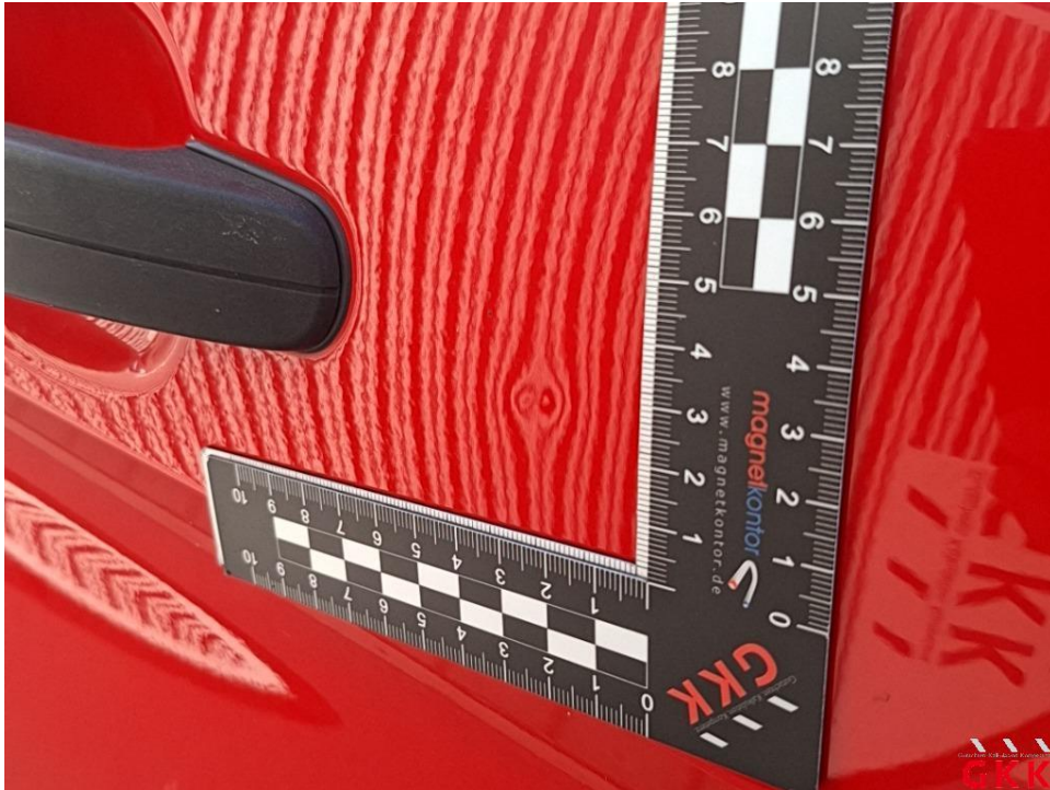
Bild 25. Tür vorne rechts, bis 3 Dellen / Bauteil, Smartrepair
