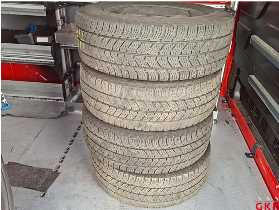
Bild 12. Reifen, 2 x beiliegend, Untermaß, ersetzen
