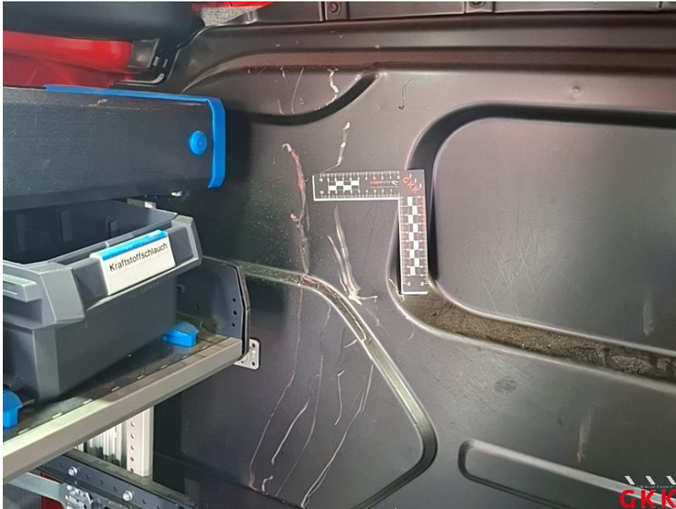
Bild 31. Trennwand, verkratzt, Smartrepair
