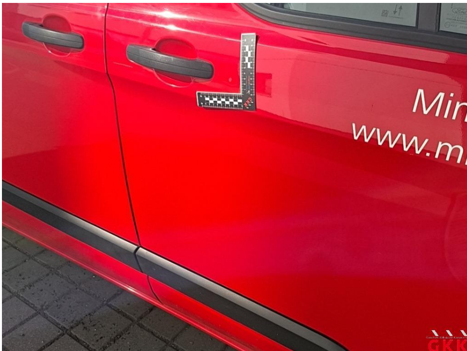
Bild 24. Tür vorne rechts, bis 3 Dellen / Bauteil, Smartrepair
