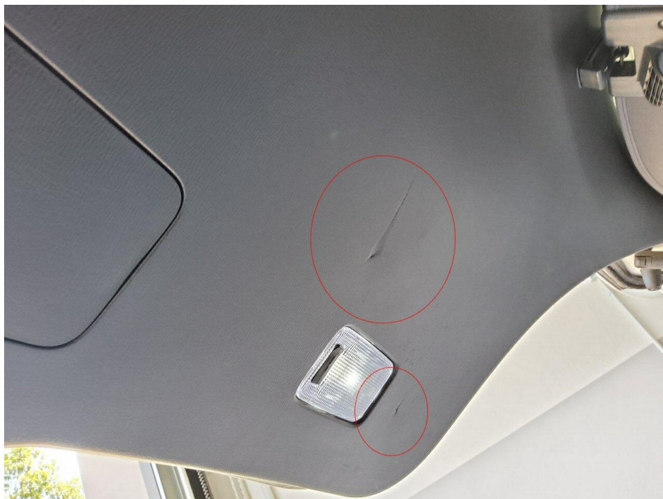
Bild 18 : Kofferdeckel Innenverkleidung verkratzt
