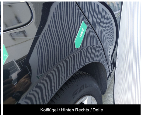
Kotflügel / Hinten Rechts / Delle
