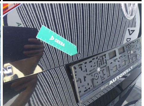
Heckklappe / Kofferraumtür / - / Delle
