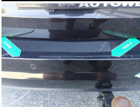
Stoßfänger / Hinten / Abgewetzt
