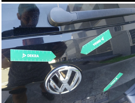
Heckklappe / Kofferraumtür / - / Delle
