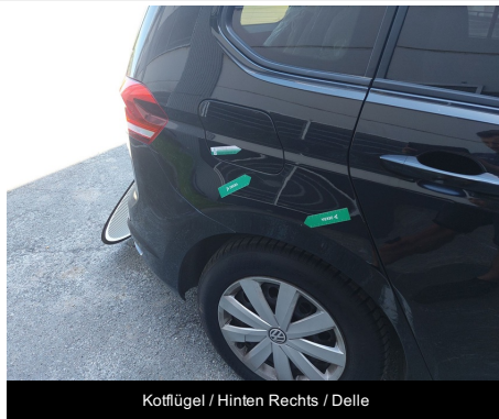
Kotflügel / Hinten Rechts / Delle
