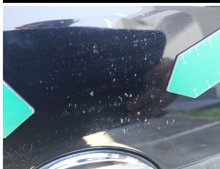
Heckklappe / Kofferraumtür / - / Delle
