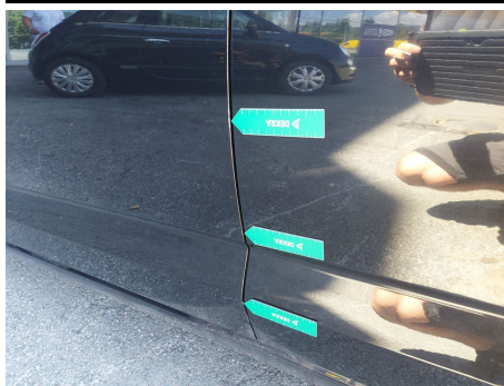
Tür / Vorne Links / Abgewetzt
