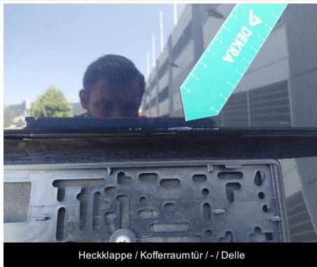
Heckklappe / Kofferraumtür / - / Delle
