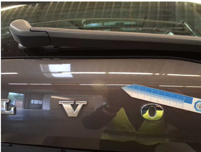
Damage 8: Boot lid / rear door: Boot lid (Vogelkotverätzung) - Paint defect - Paint
