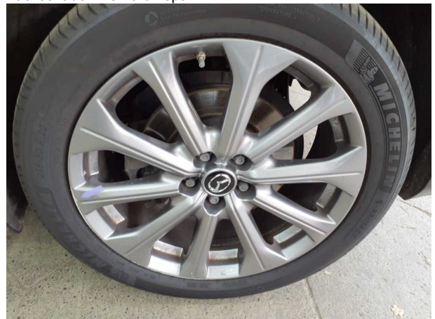
Beschädigung #7: Rad/Reifen: Leichtmetallfelge hinten links - verkratzt / verschürft - erneuern
