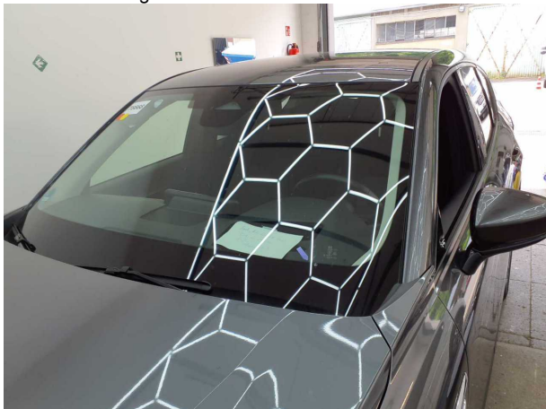
Beschädigung #12: Verglasung: Frontscheibe - Steinschlag - erneuern
