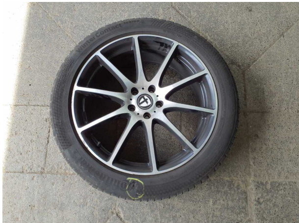
Beschädigung #1: 2.Radsatz: 2 Leichtmetallfelgen - Kratzer
