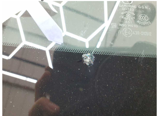
Beschädigung #12: Verglasung: Frontscheibe - Steinschlag - erneuern
