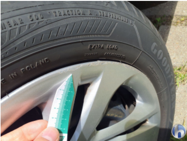
7. Radkappe - Vorne - Links Beschädigt - Erneuern
