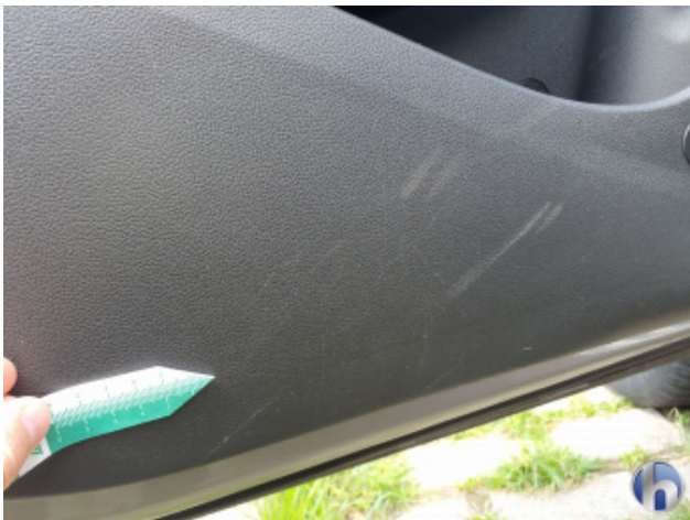
10. Verkleidung Verschmutzt - Reinigen
