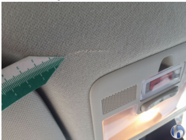
11. Dachhimmel Gebrauchsspuren - Ohne Reparatur
