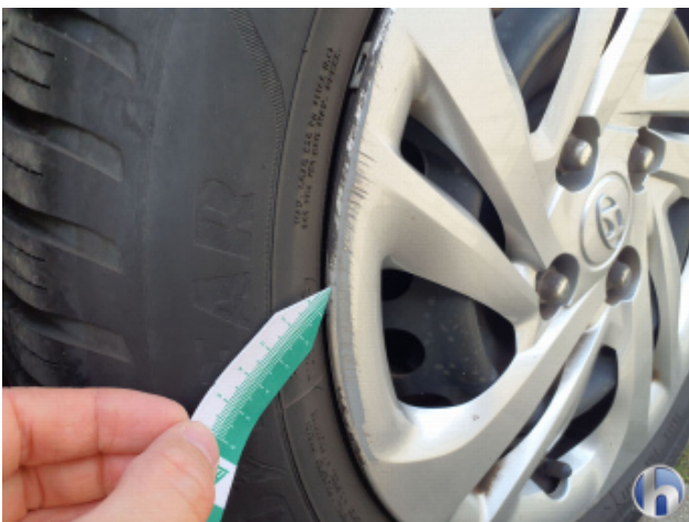
6. Radkappe - Vorne - Rechts Beschädigt - Erneuern
