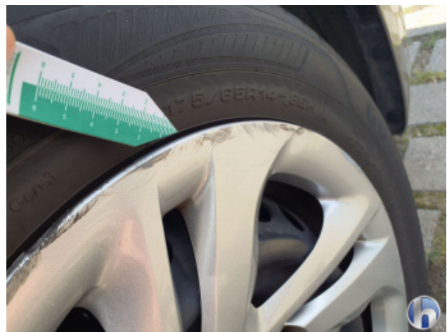
6. Radkappe - Vorne - Rechts Beschädigt - Erneuern
