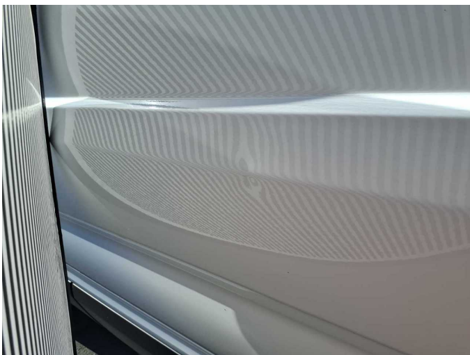
Damage 4: Sliding door - left side: Sliding door (Mit Mehraufwand) - dent(s) - Smooth repair work
