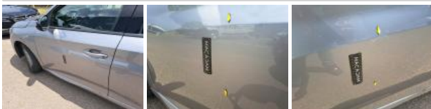
Door FL, Scratch(es), Paint
