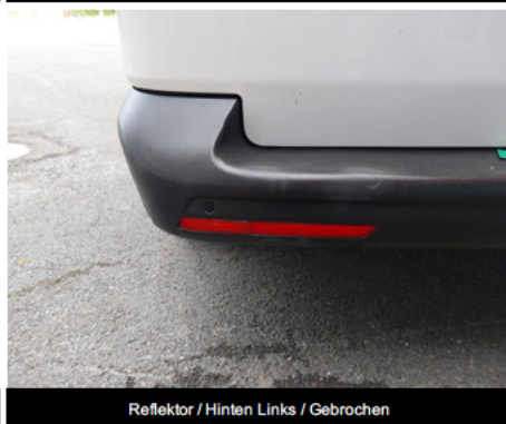
Reflektor / Hinten Links / Gebrochen
