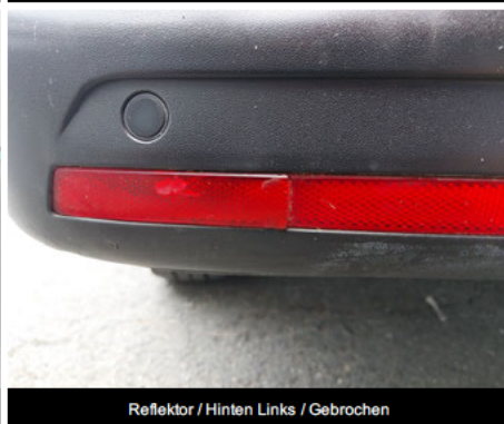
Reflektor / Hinten Links / Gebrochen
