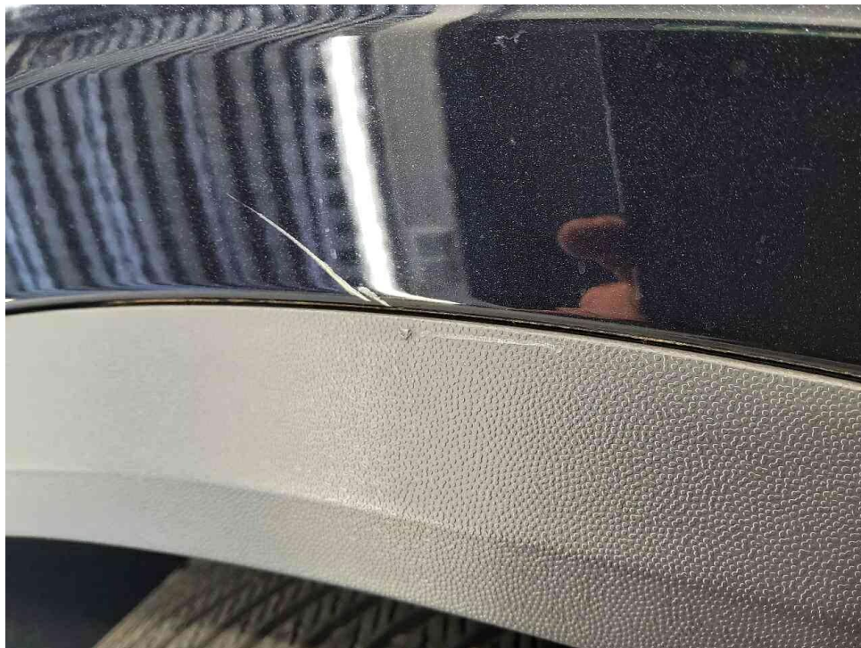
Bild 7 : Radlaufblende vorne rechts verschrammt
