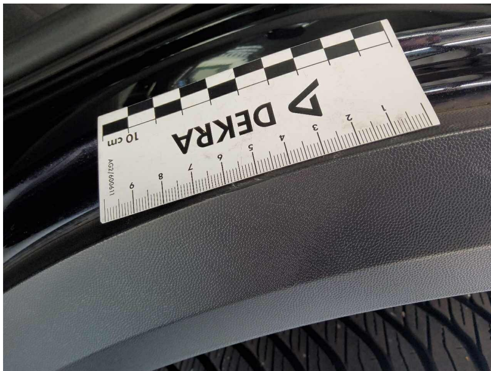
Bild 11 : Radlaufblende hinten links zerkratzt
