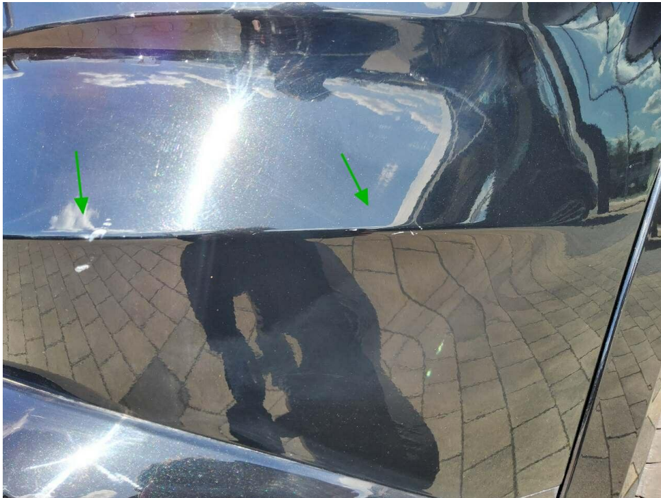
Bild 15 : Stoßfänger hinten, zerkratzt
