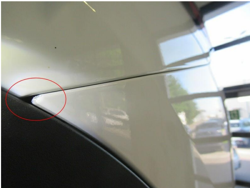
Bild 16 : Nachlackierung Stoßfängerverkleidung hinten links: Kl. Lackabplatzung
