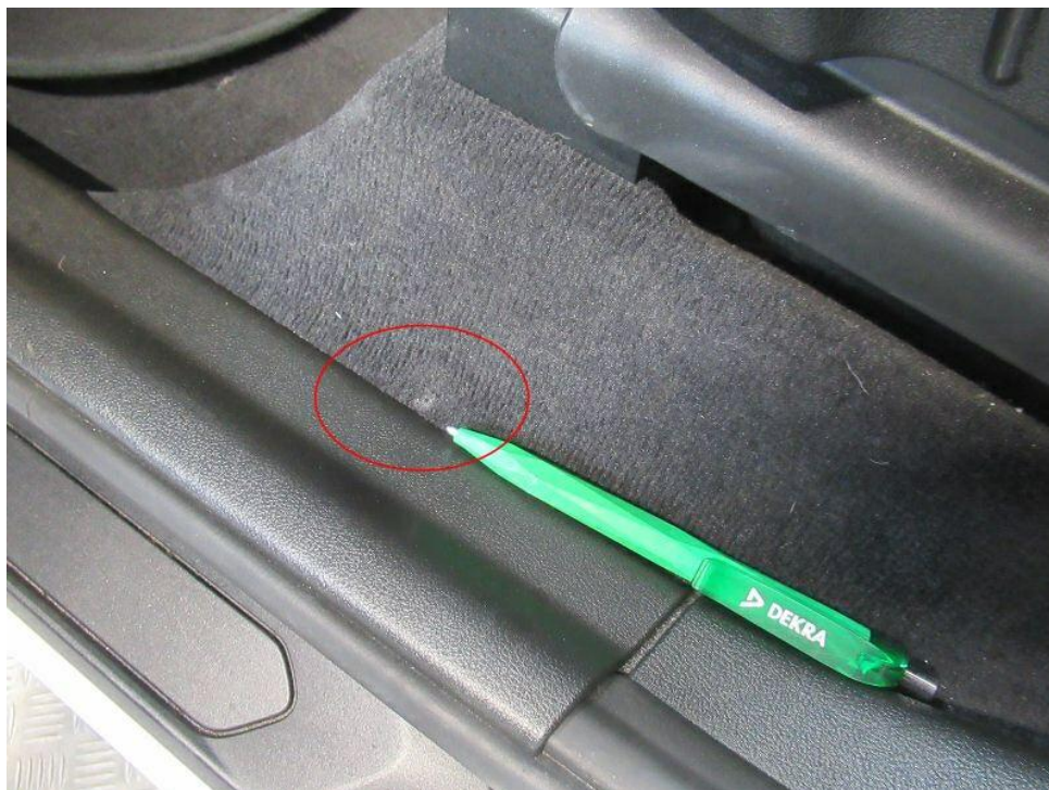
Bild 14 : Bodenbelag vorne, Brandloch, smart repair
