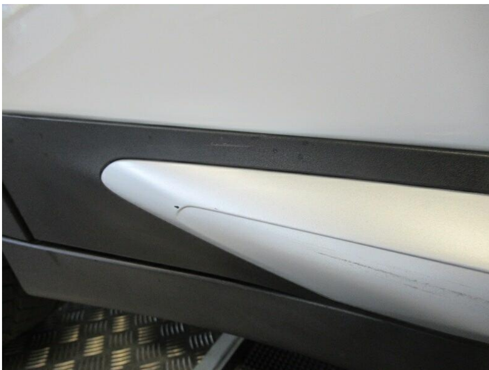
Bild 20 : Tür hinten rechts Schutzleiste unten, zerkratzt, Gebrauchsspur
