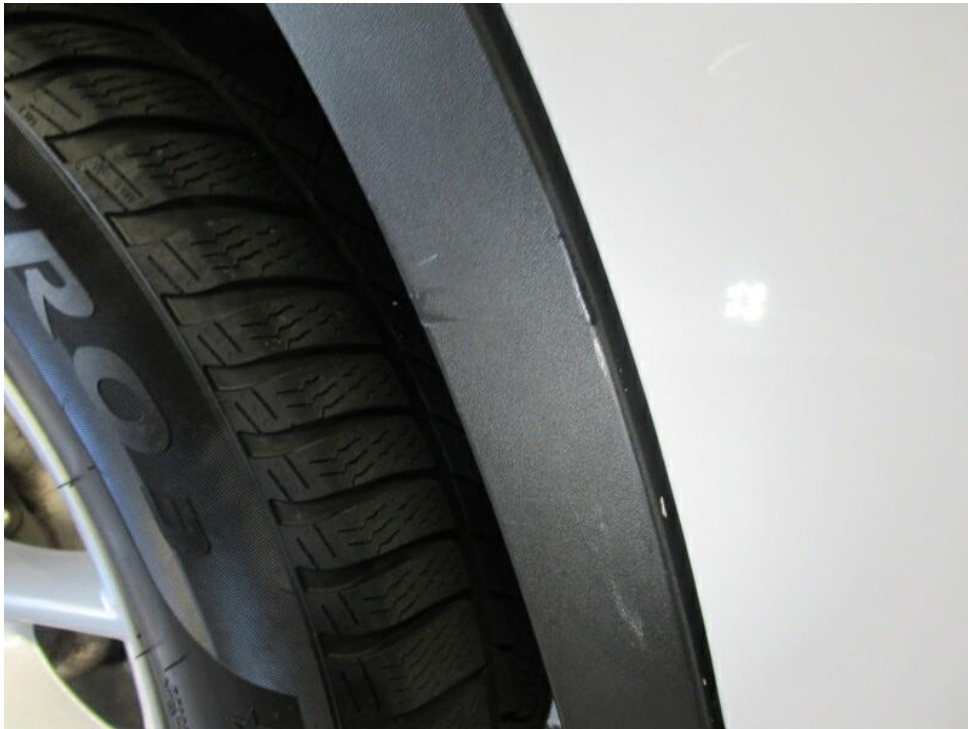
Bild 21 : Seitenteil hinten rechts Zierleiste, zerkratzt, Gebrauchsspur
