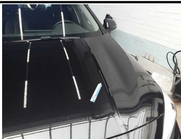
Beschädigung #9: Motorhaube: Motorhaube (+ Steinschläge... Kratzer - instandsetzen und lackieren
