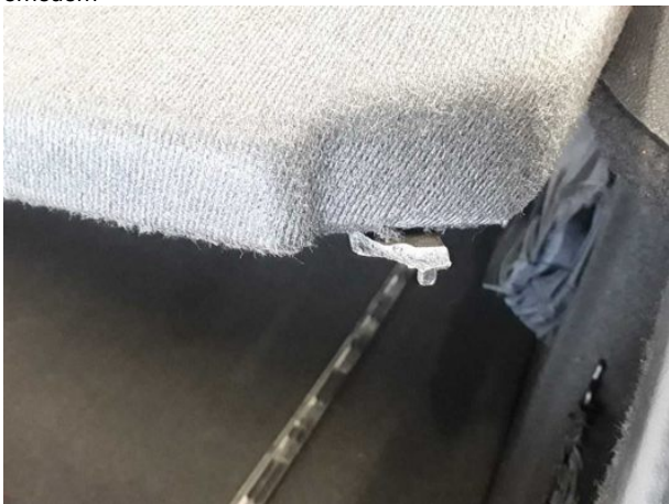
Beschädigung #4: Interieur: Hutablage - gebrochen / gerissen - erneuern
