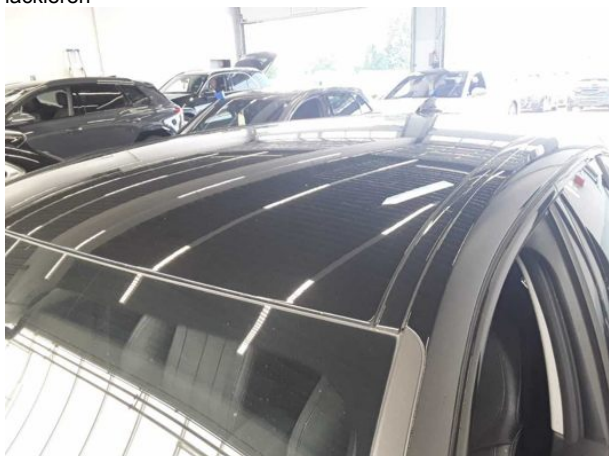
Beschädigung #2: Fahrzeugdach: Dach - Delle(n) - sanft instandsetzen
