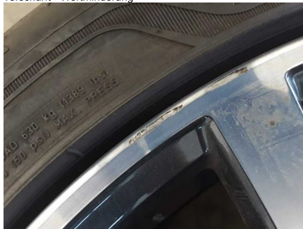
Beschädigung #5: 2.Radsatz: 3 Leichtmetallfelgen - verkratzt... verschürft - Wertminderung
