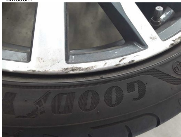
Beschädigung #5: 2.Radsatz: 3 Leichtmetallfelgen - verkratzt / verschürft - Wertminderung
