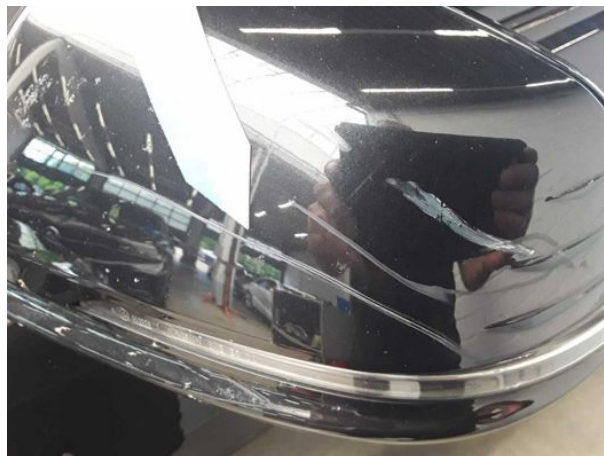
Beschädigung #1: Außenspiegel links: Abdeckkappe - Kratzer - lackieren
