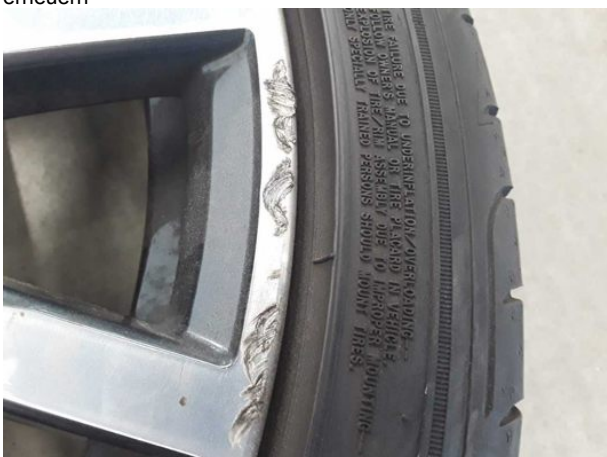
Beschädigung #5: 2.Radsatz: 3 Leichtmetallfelgen - verkratzt / verschürft - Wertminderung
