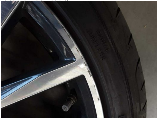
Beschädigung #5: 2.Radsatz: 3 Leichtmetallfelgen - verkratzt / verschürft - Wertminderung
