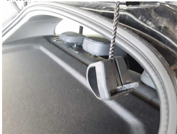
Beschädigung #4: Interieur: Hutablage - gebrochen / gerissen - erneuern
