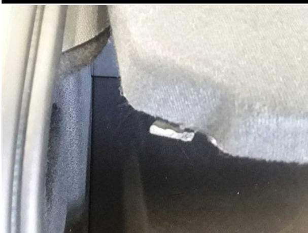
Beschädigung #4: Interieur: Hutablage - gebrochen / gerissen - erneuern
