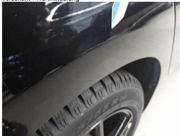
Beschädigung #6: Seitenwand rechts: Seitenwand - verkratzt... verschürft - lackieren
