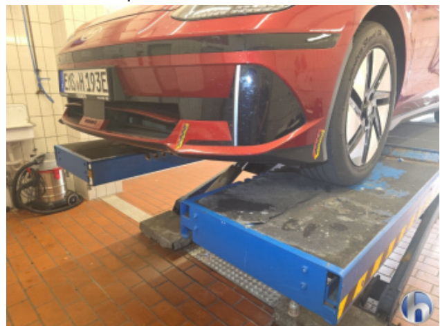
7. Frontspoiler Abschürfung - Smart Repair
