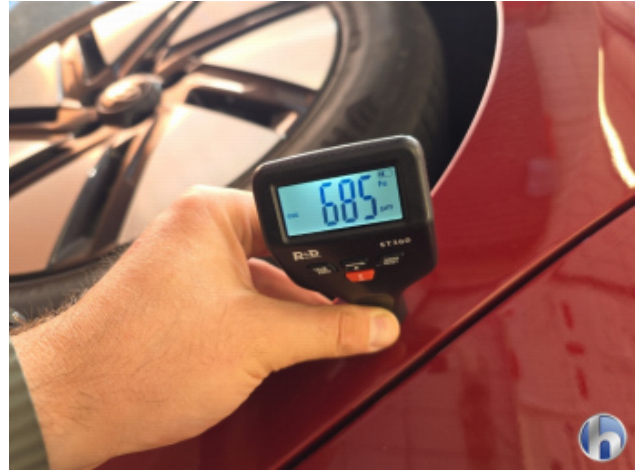
1. Seitenwand - Hinten - Rechts Nachlackiert - Ohne Reparatur
