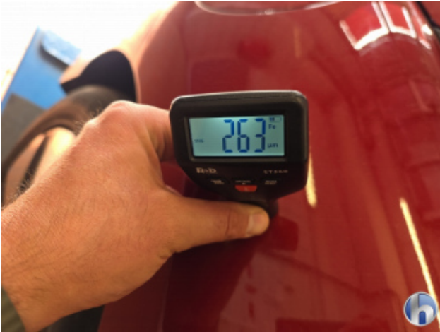
1. Seitenwand - Hinten - Rechts Nachlackiert - Ohne Reparatur
