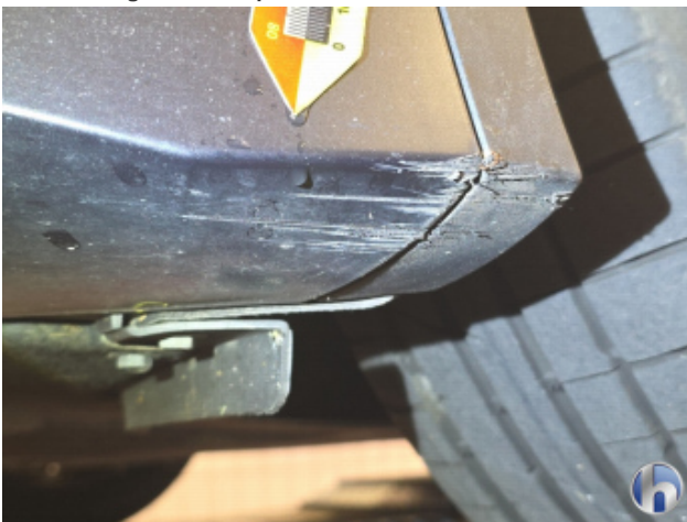
7. Frontspoiler Abschürfung - Smart Repair
