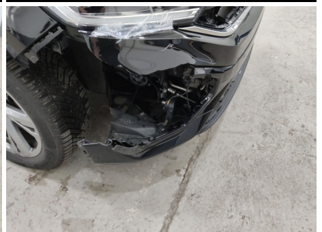
Kabelstrang / Vorne Rechts / Gebrochen
