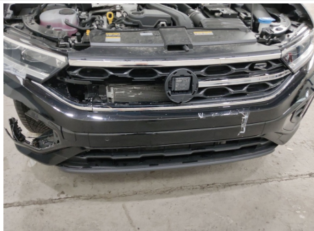
Kühlergrill / Vorne / Gebrochen
