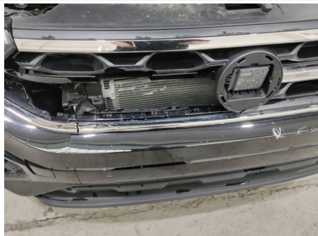
Kühlergrill / Vorne / Gebrochen
