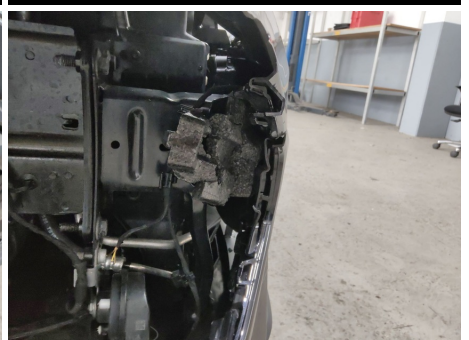
Aufprall Dämpfung / Vorne / Gebrochen
