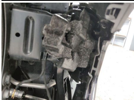
Aufprall Dämpfung / Vorne / Gebrochen
