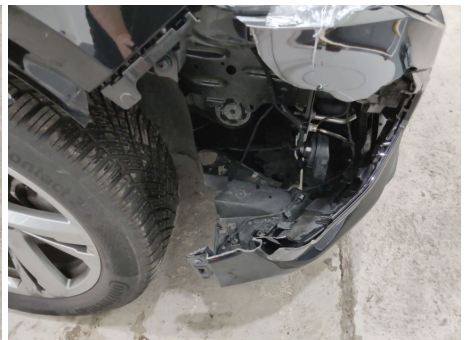
Stoßfänger / Vorne / Gebrochen
