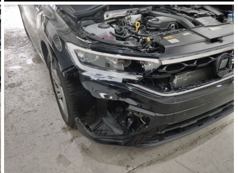
Scheinwerfer / Vorne Rechts / Gebrochen
