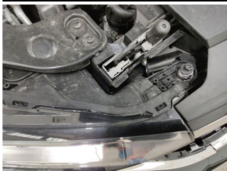
Scheinwerfer / Vorne Rechts / Gebrochen
