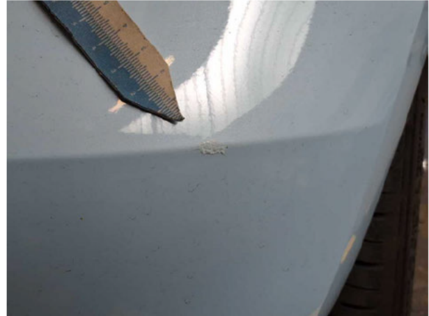
Beschädigung #1: Stossfänger hinten: Stossfänger hinten (Protokoll von der Auslieferung liegt bei) - nicht fachgerecht
