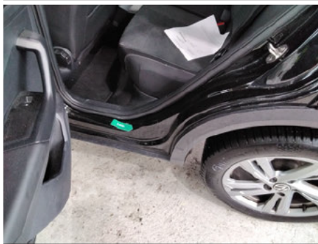
Türeinstieg / Hinten Links / Delle
