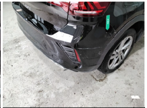
Stoßfänger / Hinten / Delle
