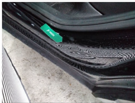
Türeinstieg / Hinten Links / Delle
