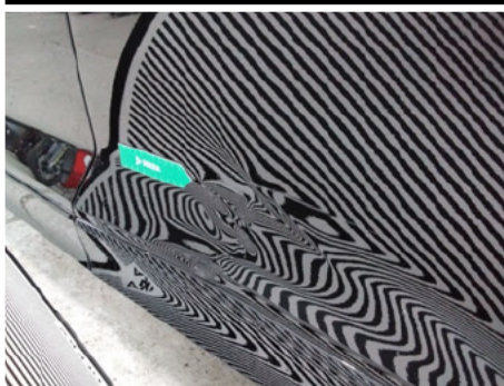
Tür / Hinten Links / Delle
