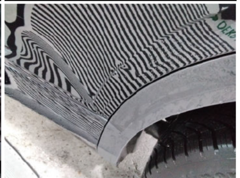
Tür / Hinten Links / Delle
