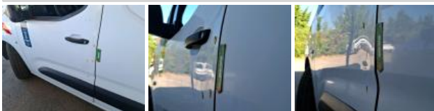
Door trim FL, Scratch(es), Replace
